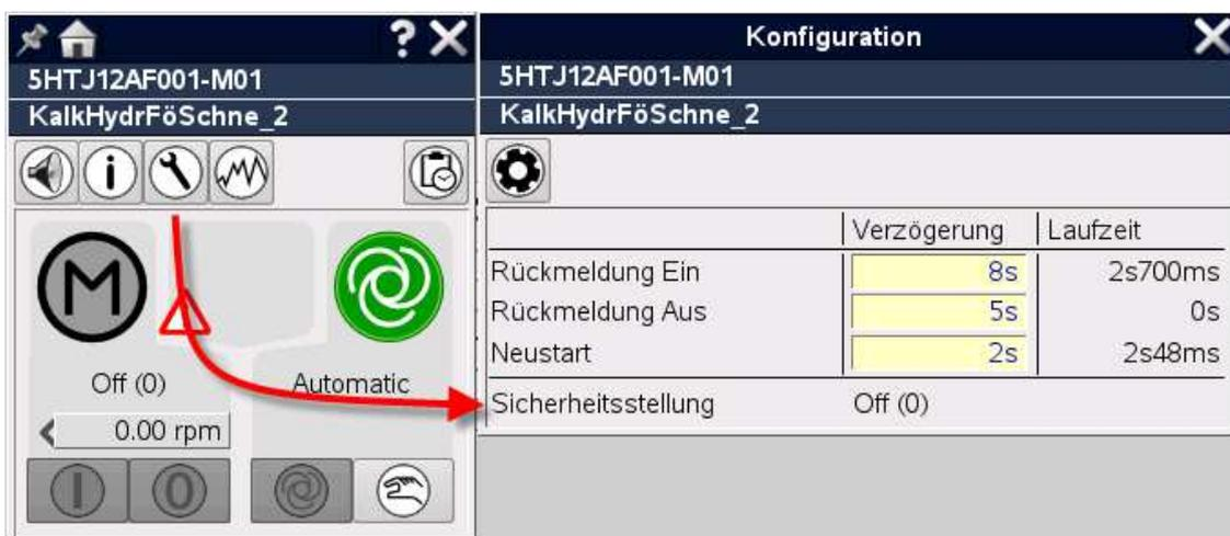
Abb. 4.19: links: Darstellung des Motor-Faceplate, rechts: Parameterfenster [64]
