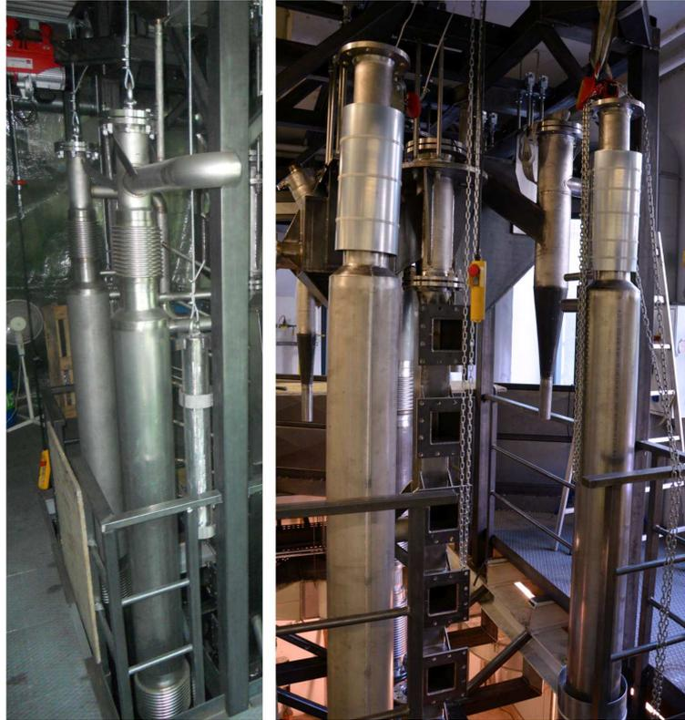
Abb. 3.10: Strahlungskühler für Produktgas und Abgas
