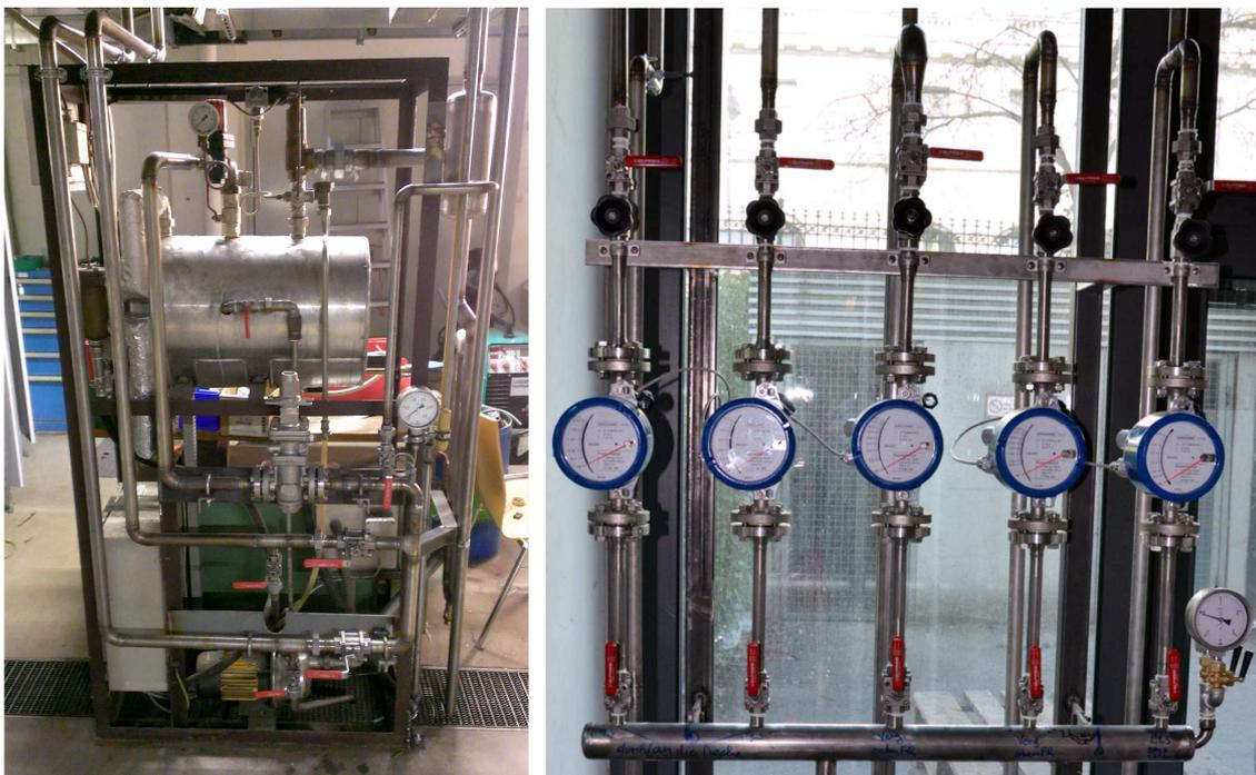
Abb. 3.7: links: Dampferzeuger, rechts: Dampf-Volumenstrommessung
