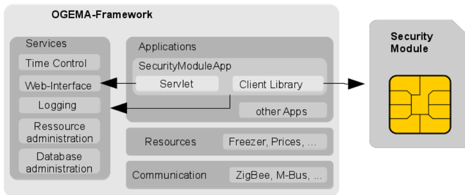
Abbildung 14: Einbindung des Sicherheitsmoduls in das OGEMA -Framework.
