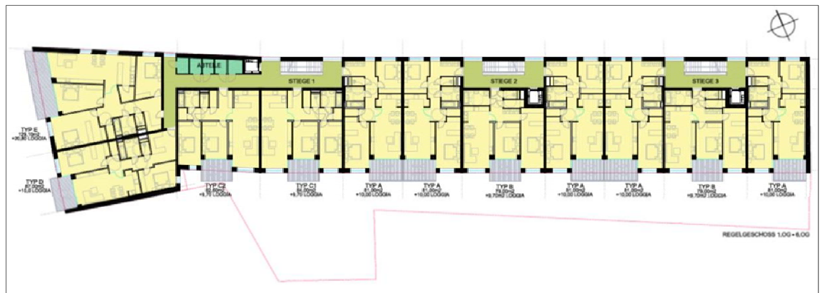
Abbildung 21: Entwurfsplan Regelgeschoss „RW 229“ (Maßstab 1:250)
