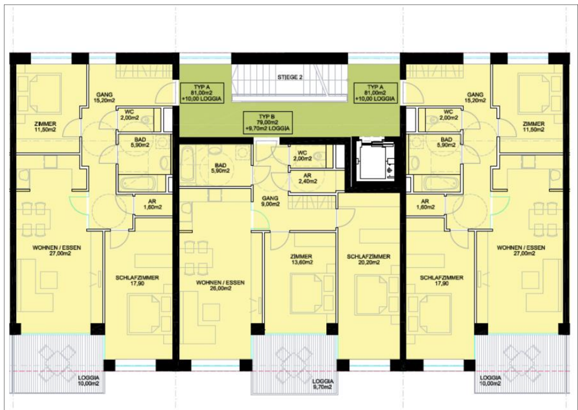
Abbildung 22: Grundrissplan einer Standardwohnung „RW 229“ (Maßstab 1:100)
