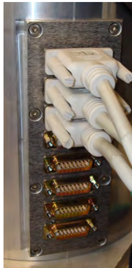
Abbildung 5.20.: Der Steckerflansch für die Kabeldurchführung der Positionierer.
