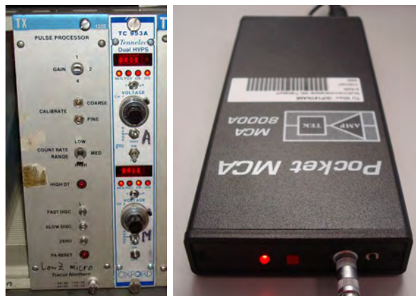
Abbildung 5.15.: Komponenten zur Signalverarbeitung und Versorgung des Detektors. Links: Pulsprozessor und Hochspannungsquelle. Rechts: Vielkanalanalysator (MCA).
