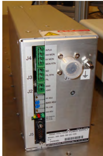
Abbildung 5.4.: Foto des Röntgenerators XR-505-50-01-OX von Matsusada Precision Inc.
