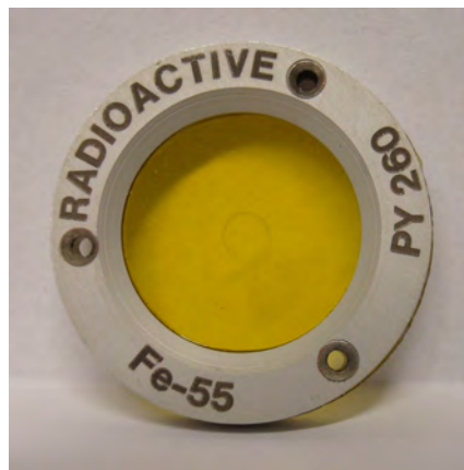
Abbildung 4.2.: ^{55}\text{Fe} -Quelle zur Detektorkalibration.
