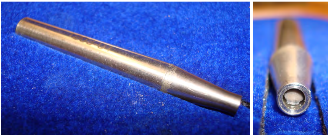
Abbildung 5.7.: Fotos der Polykapillaren Röntgenoptik. Links: Hüllrohr mit sich konisch verjüngender Austrittsseite. Rechts: Blick auf die Austrittsseite, wo im Inneren die Polykapillare zu erkennen ist.
