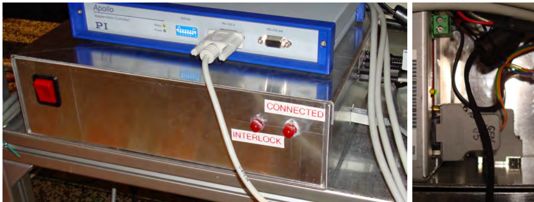
Abbildung 5.6.: Controllerbox des Röntngengenerators. Links: Die Frontplatte und rechte Seite der Controllerbox. Oben auf der Box steht sich der Controller der Positionierer für der Probe (siehe 5.3.4). Rechts: Rückseite der Controllerbox.
