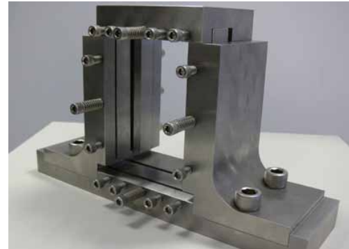
Druckwerkzeug nach Airbus, ISO und EN
