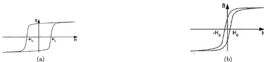
Abbildung 3.3: Hystereseschleife eines a) hartmagnetischen, b) weichmagnetischen-Werkstoffes [4]
