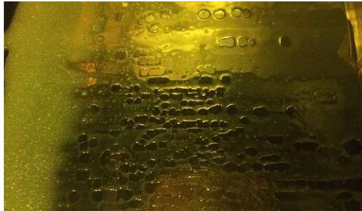
Abbildung 38: *Bild der Materialwanne mit Kane Ace Harzmischung. Es konnte keine gleichmäßige Schicht erzeugt werden. Agglomerate sind im linken Bildbereich zu erkennen.*
