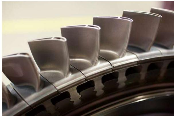
Abbildung 2: *Turbinenschaufeln für Gasturbine – Diese mittels additiver Fertigung hergestellten Rotorblätter sind für den Betrieb in Gasturbinen ausgelegt. Sie müssen einer Tangentialgeschwindigkeit von 1600km/h bei einer Temperatur von 1250°C standhalten.[2]*
