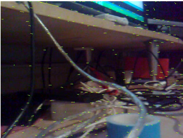
(a) Optische Fluss Vektoren vor der Rotationskompensation
