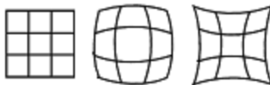
Abbildung 2.2: (Links) Quadrat ohne Verzeichnung. (Mitte) Tonnenförmige Verzeichnung, (Rechts) Kissenförmige Verzeichnung
