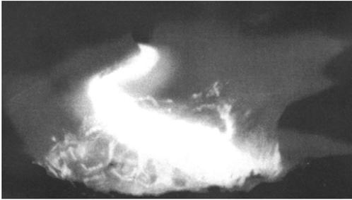
**Abbildung 29: Hochgeschwindigkeits-Aufnahme eines rotierenden Lichtbogens der Firma Messer<sup>29</sup>**
