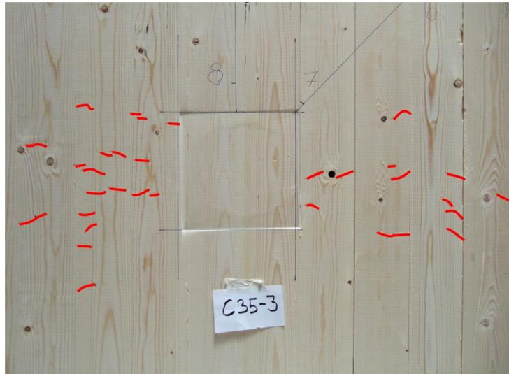
**Abbildung 1.3:** Druckfaltenbildung (rote Linien) in der Zone höchster Momentenbeanspruchung [13] (Anmerkung: 3S-Platte, Haupttragrichtung vertikal)
