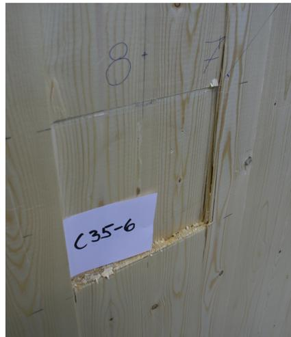
**Abbildung 1.1:** Lokale Eindrückungen mit Zugscherbruch der Längsfasern [13]
