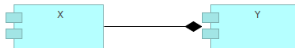
Abbildung 3.27: ArchiMate-Darstellung der Aussage „Die Applikation X ist eingebettet in die (Host-)Applikation Y.“
