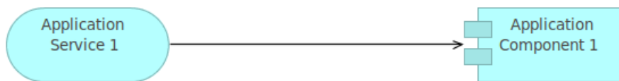
Abbildung 3.21: Abbildung des ArchiMate-Elements Used By Relationship als Verbindung eines Application Services mit einem Application Component. Quelle: Archi-Screenshot
