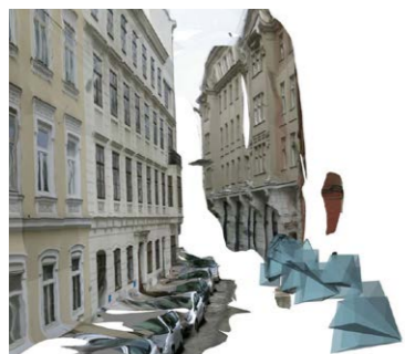
Abb. 4-16: Photogrammetrie der Tempelgasse mit Kamera-Standpunkten (Pyramiden)
