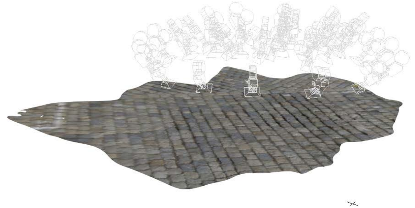
Abb. B-66: Photogrammetrie-Modell mit Kamerapositionen
