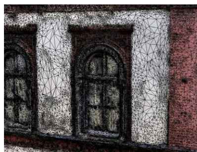
Abb. 4-18: Nahansicht des Modells des Seitentrakts, Drahtgitterauflösung erkennbar
