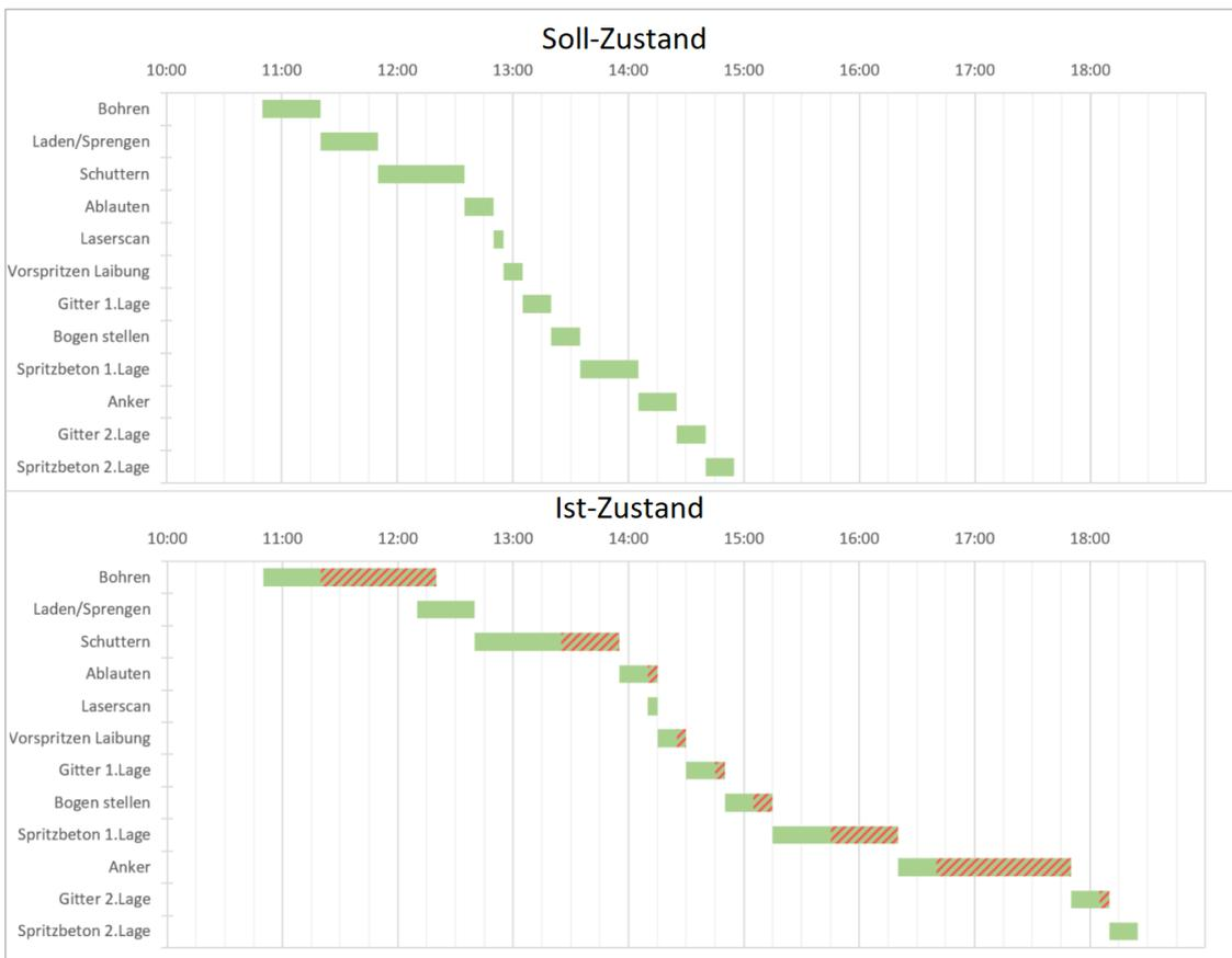
**Abb. A.1:** Gegenüberstellung der Zyklusdiagramme von Soll- und Ist-Zustand bei Störungsszenario 1 – verringerte Partiestärke – im realen Tunnelbauprojekt
