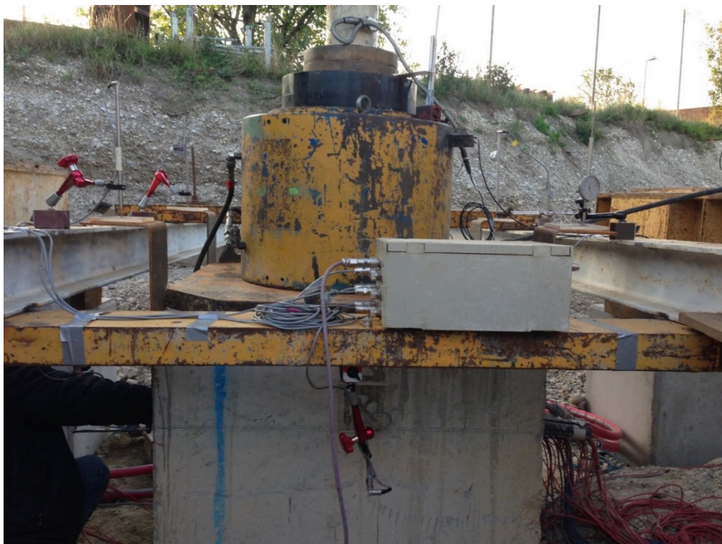
Abb. 4.31: Messbrücke mit aufmontierten Wegaufnehmern - MWES I
