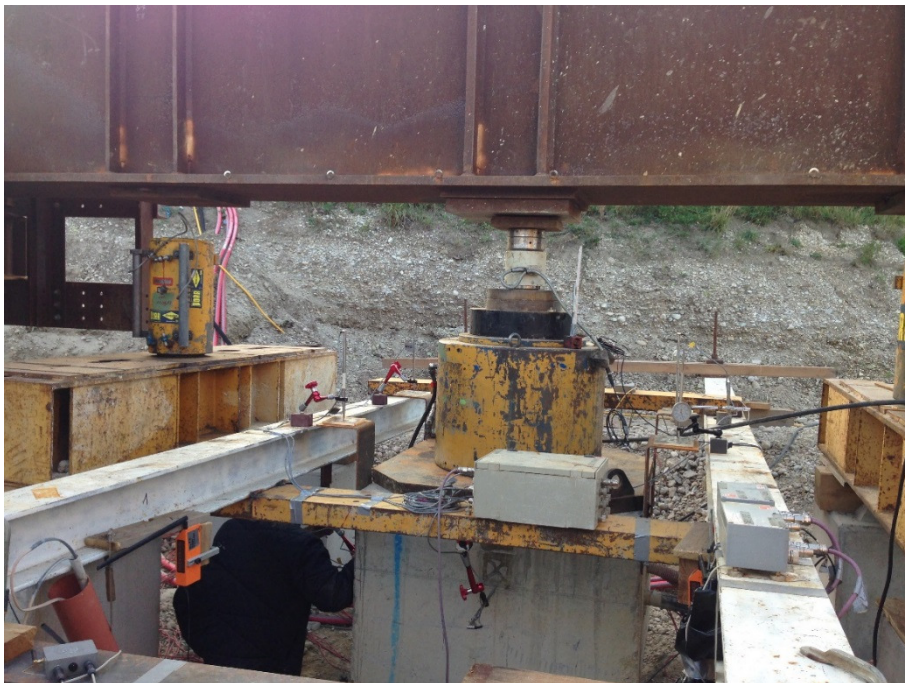
Abb. 4.26: Hydraulikpresse mit Kraftmessdose (Kiespfahl B.EK)
