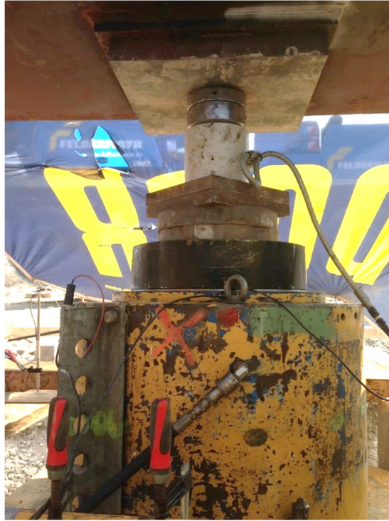
Abb. 4.34: Kraftmessdose auf hydraulischer Presse - MWES I
