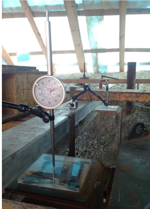
Abb. 4.33: Vorne: Mechanische Messuhr, Hinten: Vertikaler Wegaufnehmer - MWES I
