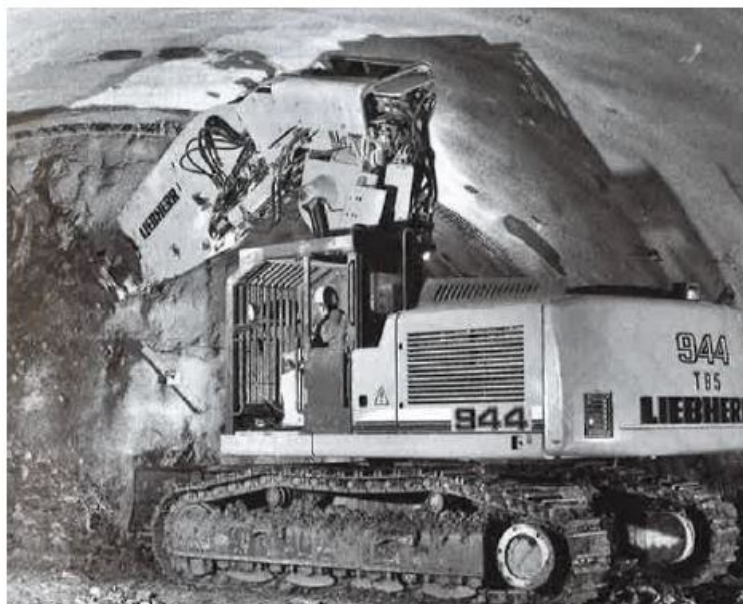
Abb. 2.7: Tunnelbagger mit zweimal 45^\circ um die Längsachse schwenkbarem Arm [55]
