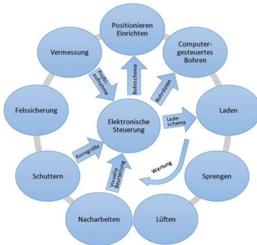
Abb. 5.6: Elektronisch gesteuerter Sprengzyklus, adaptiert nach [34]
