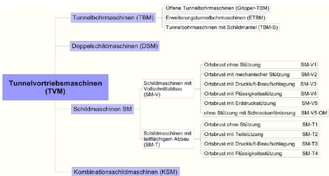
Abb. 2.9: Einteilung der Tunnelvortriebsmaschinen (TVM) [9]
