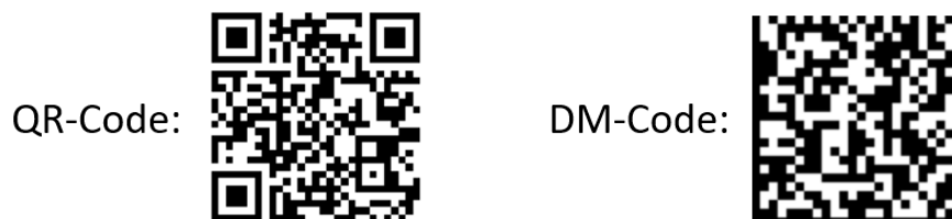
Abbildung 21: maschinenlesbare Beschriftung; Zwei unterschiedliche Standards: QR...Quick-Respons und DMC... Data Matrix Code
