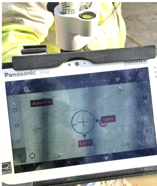
Abb. 2.16: Tablet des Absteckgerätes 60
