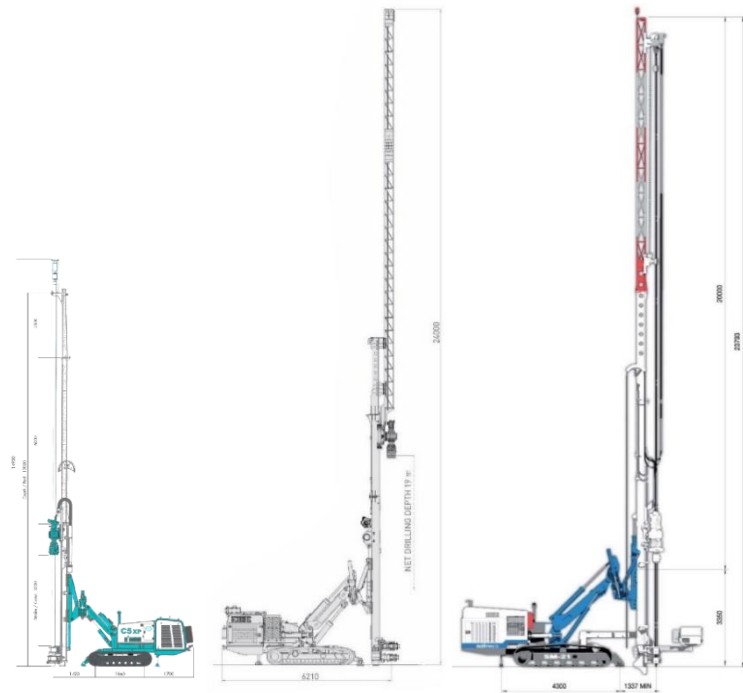
Abb. 2.24: Größenvergleich der Bohrgeräte, links: C5XP 93 , Mitte: MC15P 94 , rechts: SM-21 95
