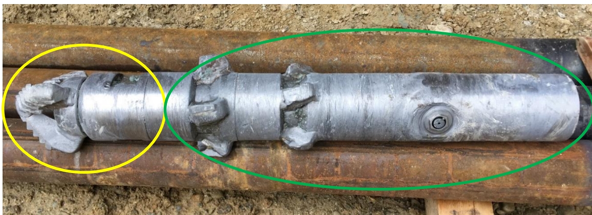
Abb. 2.14: Bohrkrone für Spülbohrungen (gelb) und Monitor (grün) 44
