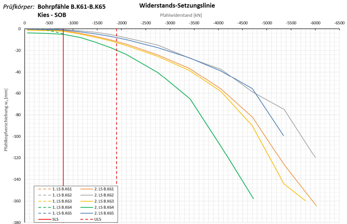
Abb. 9.36: Widerstands-Verschiebungslinie Großbohrpfähle SOB Kies B.K61-B.K65
