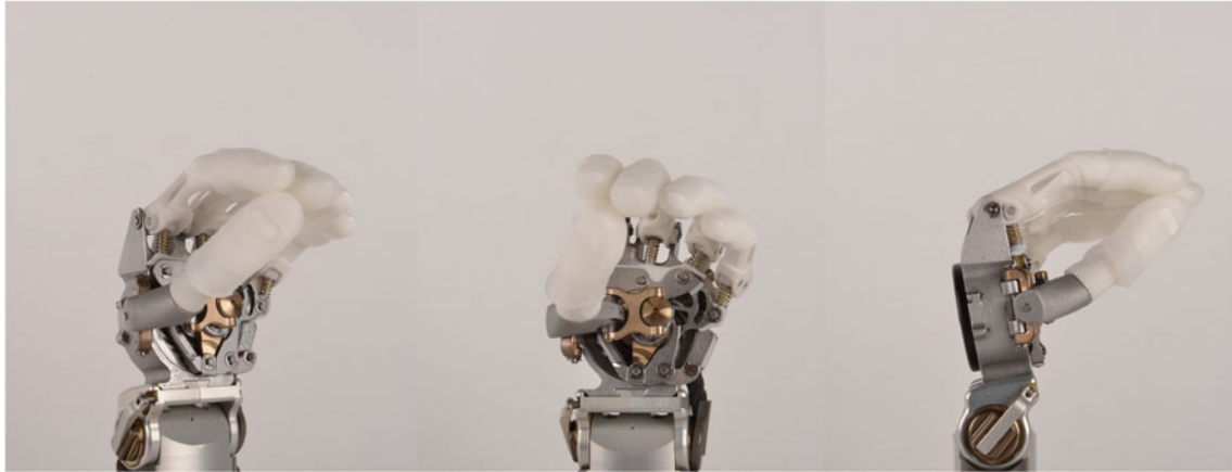
Abbildung 59: Endprodukt: „Tripod Pinch“-Handstellung
