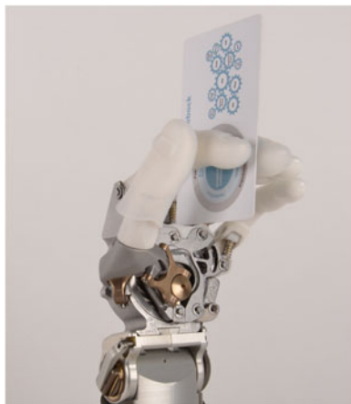
Abbildung 64: „Finger Ab-/Adduction“-Handstellung mit der Michelangelo® Hand S
