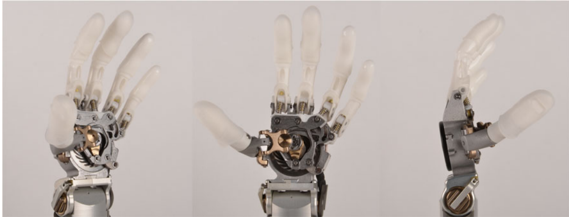
Abbildung 58: Endprodukt: „Opposition Power Grip“-Handstellung
