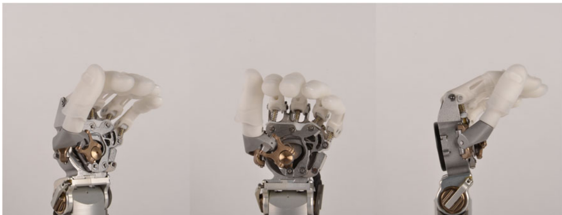
Abbildung 55: Endprodukt: „Lateral Pinch“-Handstellung
