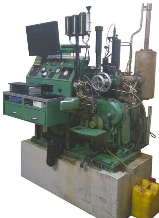
Abb. 2-11: CFR-Prüfmotor für die Bestimmung der Cetanzahl am IFA-Institut der TU-Wien
