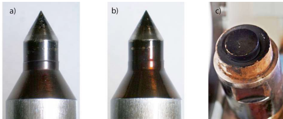
Abb. 4-24: Düse und Düsennadel am BASF-Motor a) gereinigte Düsennadel, b) verschmutzte Düsennadel nach B100, c) verschmutzte Düsen nach B100
