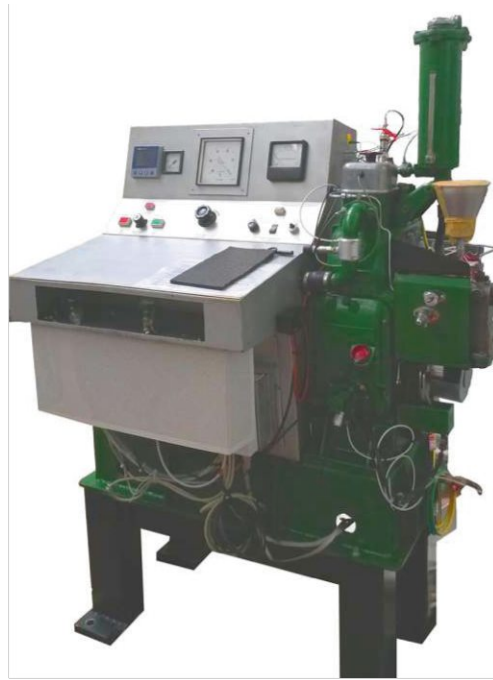
Abb. 2-13: BASF-Prüfmotor zur Bestimmung der Cetanzahl am IFA-Institut der TU-Wien
