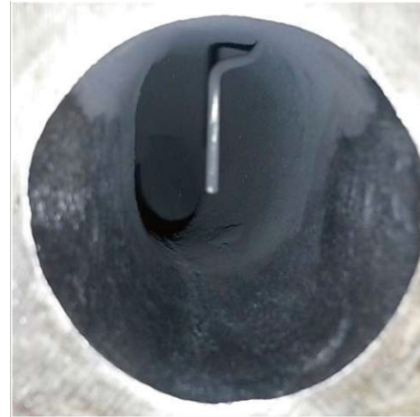
Abb. 3-4: Thermoelement (Typ K) im Saugkanal
