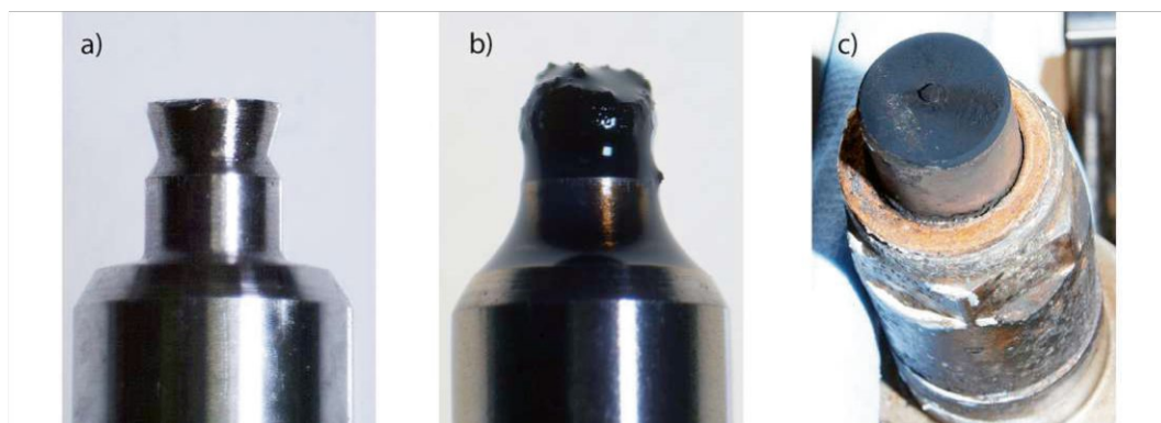
Abb. 4-20: Düse und Düsennadel am CFR-Motor a) gereinigte Düsennadel, b) verschmutzte Düsennadel nach B100, c) verschmutzte Düse nach B100
