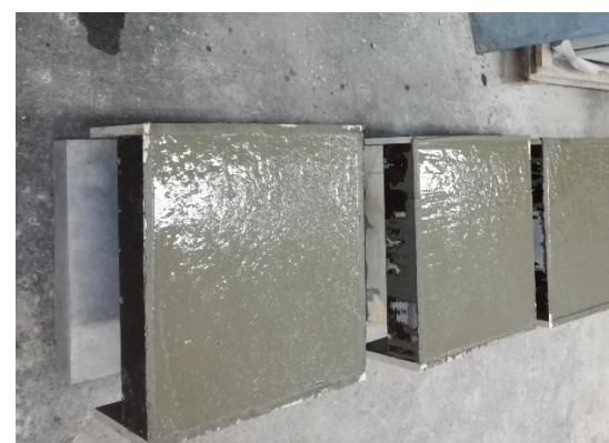
Abbildung 5.3: Bildergalerie: Prüfkörperherstellung in der Halbfertigteil-Bauweise
