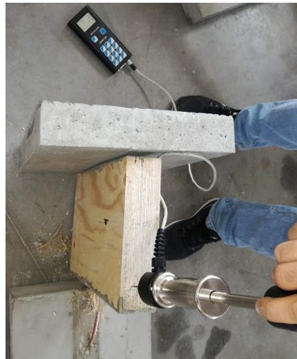
Abbildung 5.7: Holzfeuchteermittlung nach DIN EN 13183-2 [45]
