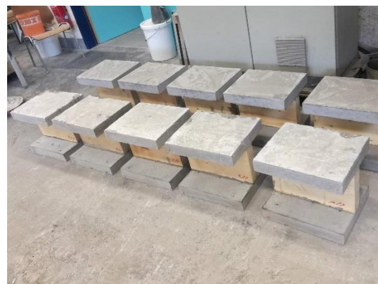
Abbildung 5.3: Bildergalerie: Prüfkörperherstellung in der Halbfertigteil-Bauweise
