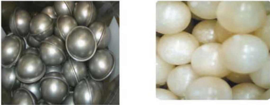
Abbildung 20: PCM-Makrokapsel mit Stahl (links) und Polyolefin (rechts) Hülle [25]
