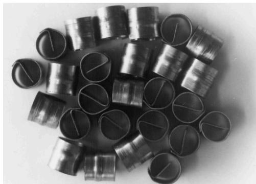
Abbildung 17: Von Velraj verwendetes Füllmaterial, sogenannte Lessingringe [34]
