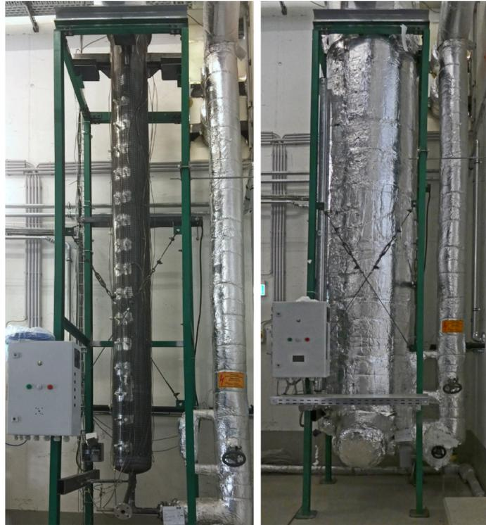
Abbildung 47: LESY 2 (links) ohne und (rechts) mit Wärmedämmung [12]
