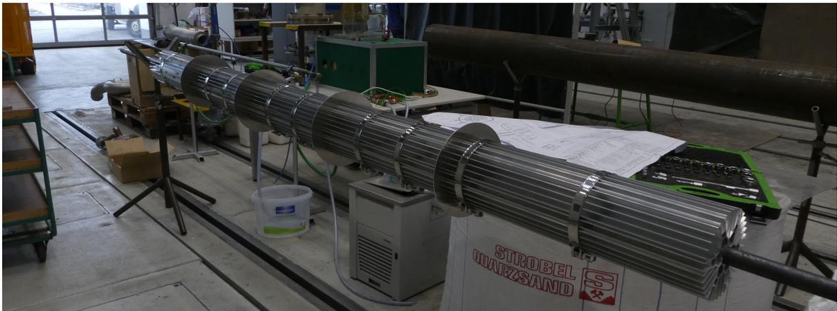
Abbildung 42: Foto des zusammengebauten Wärmetauschers von LESY 2, Foto von Viktoria Illyés 2018 TU
