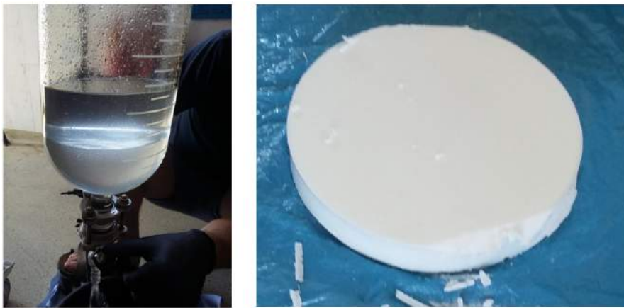
Abbildung 4.10: Abtrennung der wässrigen Phase (untere Phase) mittels Scheidetrichter
