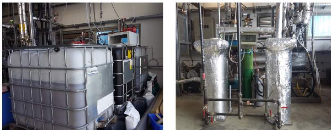
Abbildung 4.6: RME-Wäscher und Aktivkohlefilter
