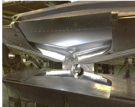
Abbildung 4.2: Breitschlitzdüse: a) Breite durch Führungsbacken veränderbar, b) auswechselbare Lippe, c) Hydraulische Werkzeugöffnung und -verklammerung, d) Extruder
