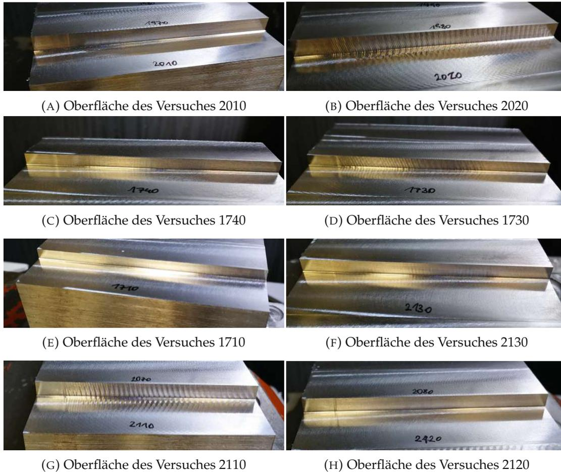
ABBILDUNG 3.7: Vergleich der Oberfläche mehrerer Schnitte
