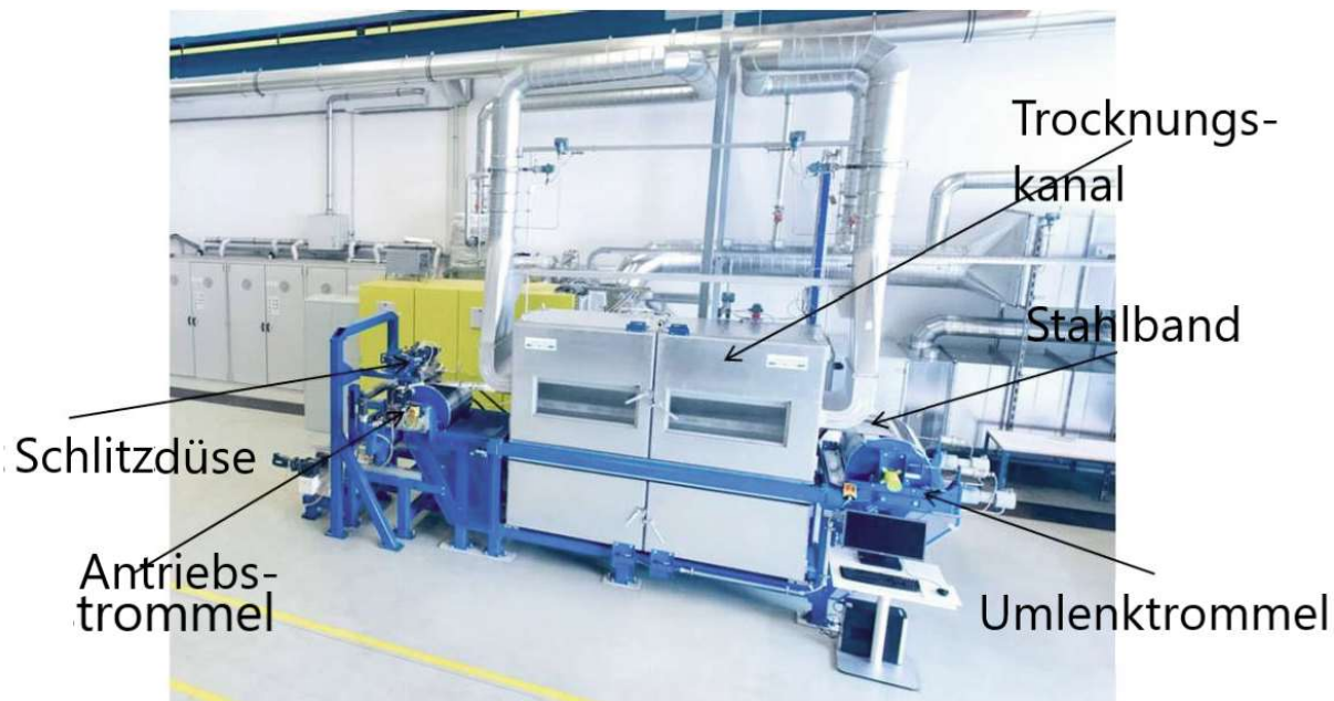
Abbildung 3: Bild des LabCasters im Testcenter mit der Schlitzdüse und der Antriebs-trommel links, dem Trocknungskanal mit Stahlband mittig und der Umlenktrommel rechts
