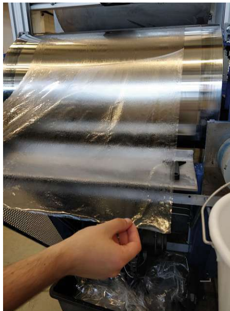
Abbildung 33: Foto beim Abziehen von PVOH (V7) mit kleinen eingeschlossenen Luftblasen aufgrund der schaubildenden Eigenschaften der Gießlösung
