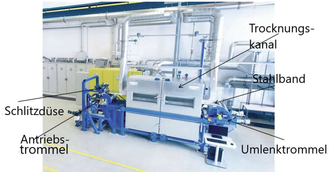
Abbildung 8: Bild des LabCaster im Testcenter mit der Schlitzdüse und der Antriebstrommel links im Bild, dem Trocknungskanal mit Stahlband in der Mitte und die Umlenktrommel auf der rechten Seite.
