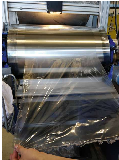
Abbildung 29: Darstellung des Abziehverhaltes des Polymerfilms nach der Trocknung an der Umlenktrömmel
