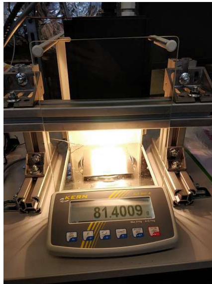
Abbildung 27: Darstellung der Waage während einer Messung. Die Probenplatte ist mittig platziert und 10 cm darüber befindet sich die Messoptik.
