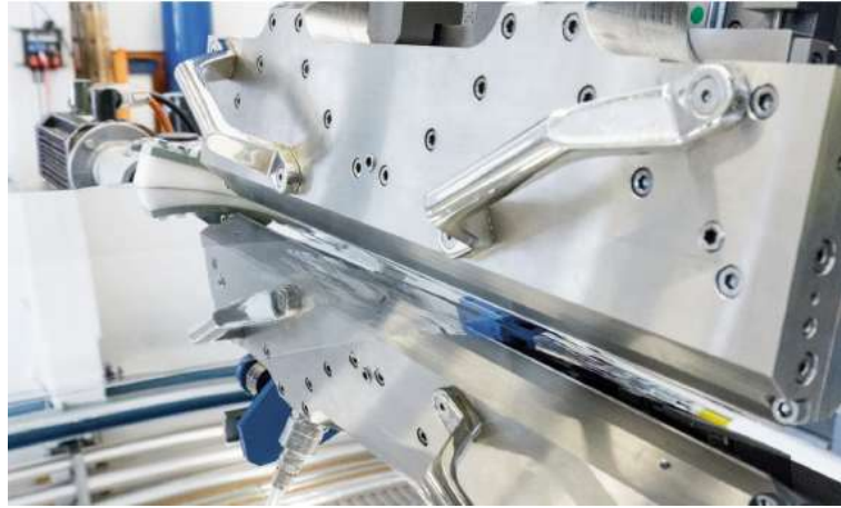
Abbildung 26: Bild der verwendeten Schlitzdüse über dem Stahlband
