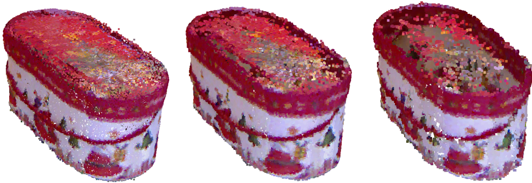
Abbildung 4.11: Auswirkung des Winkelabstands. (links) Modellierung erfolgte mit \psi = 1^\circ , (Mitte) Modellierung erfolgte mit \psi = 5^\circ , (rechts) Modellierung erfolgte mit \psi = 15^\circ .
