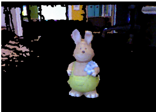
Abbildung 3.20: Mittels RANSAC wurde der Boden entfernt.
