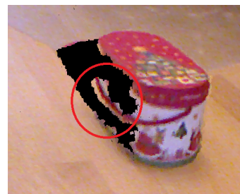
Abbildung 3.3: Detailansicht einer Aufnahme. An Kanten ist die Tiefeninformation oftmals falsch.
