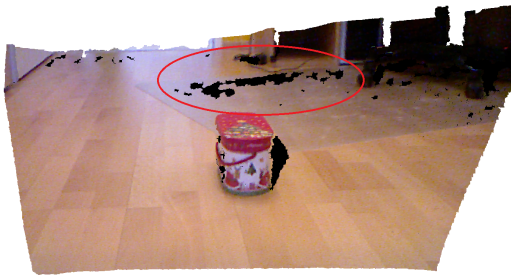
Abbildung 3.2: Aufnahme mit einer Microsoft Kinect. Im markierten Bereich ist keine Tiefeninformation verfügbar.
