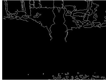
Abbildung 3.18: Mit der Canny-Kantenerkennung wurden die Tiefsprünge erkannt.
