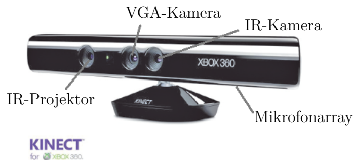
Abbildung 3.1: Abbildung eines Microsoft Kinect Sensors und ihrer Komponenten, vgl. [1].
