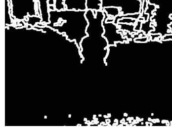
Abbildung 3.19: Die gefundenen Kanten werden mittels anisotroper Filterung verbreitert.
