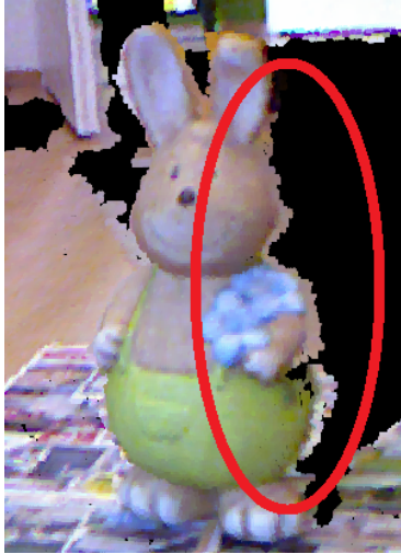
Abbildung 3.15: Unbearbeitete Punktwolke wie sie von der Microsoft Kinect erzeugt wird. Im markierten Bereich erkennt man, dass falsche Punkte zum Objekt hinzugefügt wurden.
