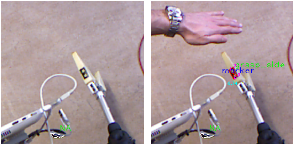
Abbildung 7.5.: Probleme der Mustererkennung durch Spiegelung am Pattern. Im linken Bild ist die Spiegelung in Form eines hellen Flecks erkennbar. Dies führt zu Problemen bei der Erkennung des Patterns. Wird die direkte Beleuchtung mit der Hand abgeschottet (rechtes Bild), kann das Pattern einwandfrei erkannt werden.
