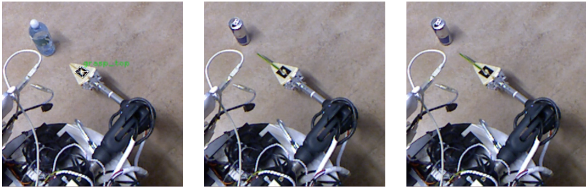
Abbildung 7.8.: Greifererkennung eines Bleistifts in der unteren Greifposition (Bodennähe).
