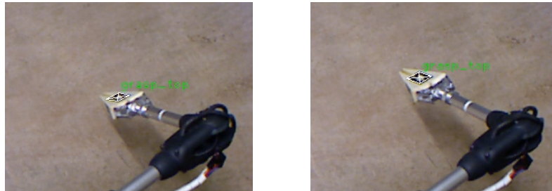
Abbildung 7.14.: Videoausschnitte der Rotation des leicht geöffneten Greifers (Achse 1 bei 42^\circ bzw. bei 53^\circ ).
