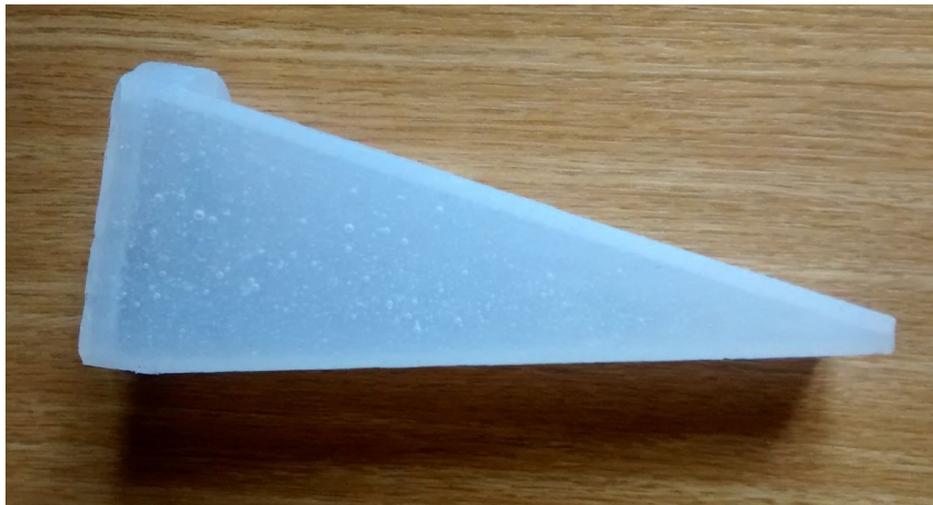
Abbildung 5.10.: Dragon Skin Überzug. Der, aus zwei Teilen bestehende, Korpus wurde mit transparenter Dragon Skin 20 befüllt. Anschließend wurde der 3D-gedruckte Greiferteil hinzugefügt. Nach der Aushärtezeit des Zwei-Komponenten-Materials konnte der Überzug von den Gussteilen abgezogen und verwendet werden.
