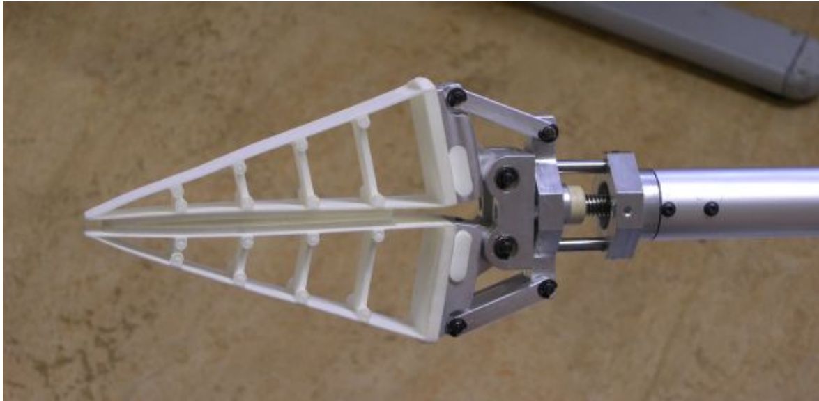
Abbildung 5.1.: Geschlossener Greifer mit Festo-Fingern. Die Finger werden durch die, von einem Elektromotor angetriebene, Spindel am Handgelenk geöffnet und geschlossen. Sie passen sich an die, sich im Greifer befindlichen, Objekte an.
