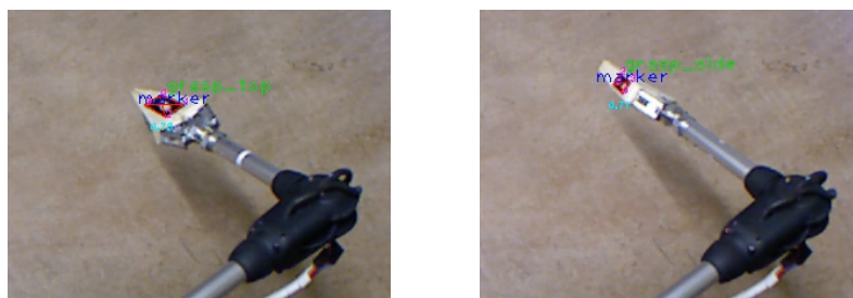
Abbildung 7.13.: Videoausschnitte der Rotation des geschlossenen Greifers (Achse 1 bei 60^\circ für die „perfekte“ Erkennung des top-Patterns bzw. bei 68^\circ für die „perfekte“ Erkennung des side-Patterns). Für die Erkennung des side-Patterns wurde ebenfalls eine Rotation der Achse 5 durchgeführt.
