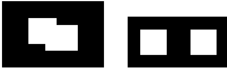
Abbildung 6.24.: Greiferpatterns. Im linken Bild ist das top-Pattern (auf der Oberfläche) und im rechten das side-Pattern (an der Seite des Greifers) dargestellt.
