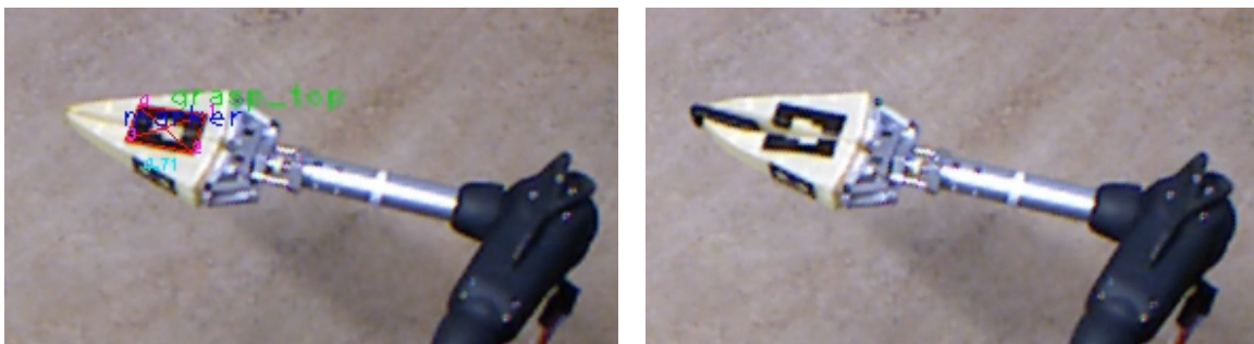
Abbildung 7.9.: Greifererkennung eines USB-Sticks in der oberen Greifposition (Tischnähe).
