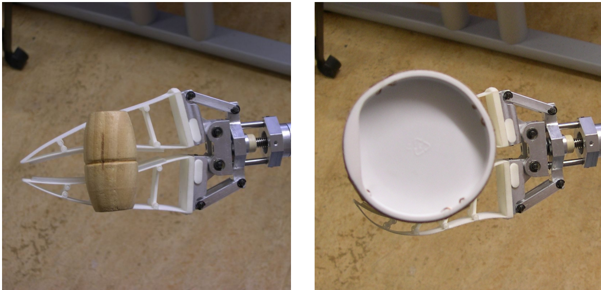
Abbildung 5.3.: Teilweise durch ein Objekt verdeckter Greifer. Je nach Form und Größe des Gegenstandes werden die Finger des Greifers oder sogar der komplette Greifer verdeckt. Im Falle des kleinen Holzhammers im linken Bild findet nur eine geringe Okklusion des Greifers statt. Im Vergleich dazu sind im rechten Bild durch die massive, lange Kartonrolle beinahe beide Greiferfinger zur Gänze verdeckt.
