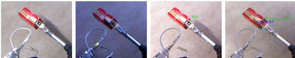
Abbildung 7.6.: Beleuchtungsprobleme: In allen Szenen wurde das direkte Tageslicht abgeschottet. Links ist die reale Szene mit direkter künstlicher Beleuchtung (Leuchtstoffröhre) dargestellt. Im zweiten Bild von links wurde die künstliche Beleuchtung abgeschaltet. In der dritten und vierten Szenen wurde nur die direkte Beleuchtung durch ein Blatt bzw. ein dunkles Tuch unterbunden. Dies verhindert Spiegelungen an den Patterns und führt zur einwandfreien Identifikation (letztes Bild ganz rechts).
