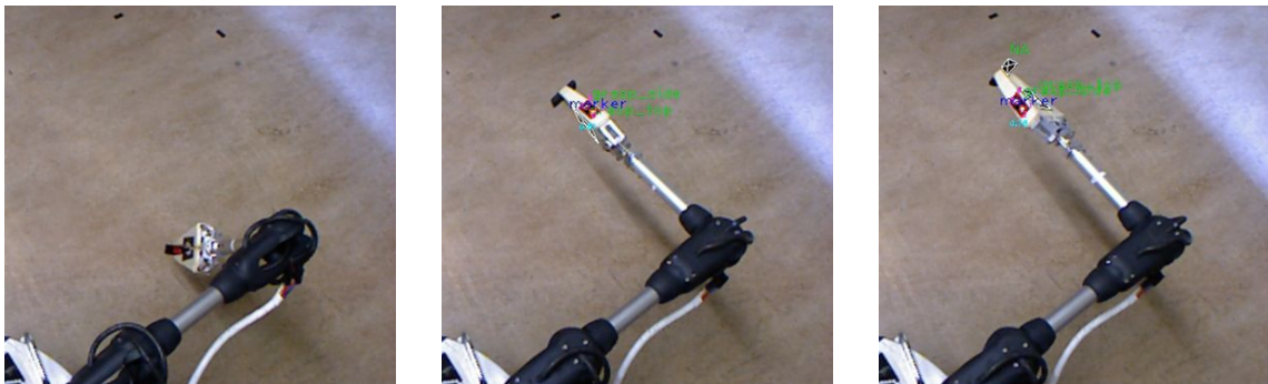
Abbildung 7.17.: Videoausschnitte der Rotation des Greifer mit USB-Stick (stehend). Bei zwei extremen Schräglagen kommt es auch hier zu einer falschen Erkennung des top-Patterns.
