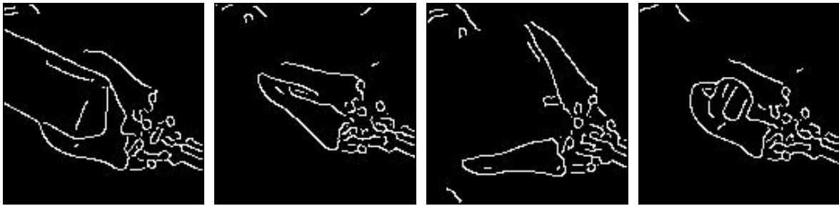
Abbildung 6.16.: Ergebnisse des Canny-Algorithmus bei überzogenem Greifer mit Überzug V1 (von links nach rechts, mit einer Kartonbox, geschlossener, offener Greifer und mit einem Handy).
