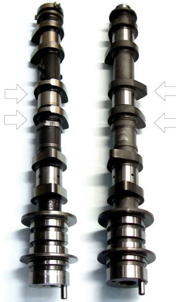
*Abbildung 3.39: Vergleich der Nockenwellenvarianten: links Standardvariante, rechts 60° KW verschränkt.*
