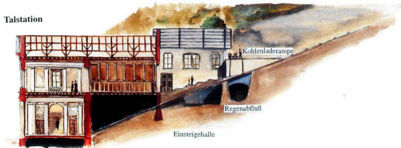
Abb.31: Schnittansicht Talstation Drahtseilbahn
