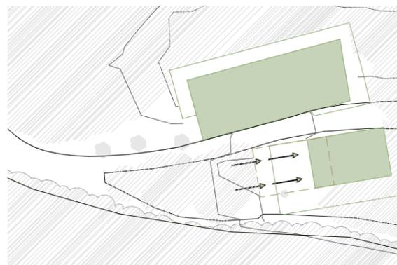
Phase 2 - Verschiebung des Frühstücksbereiches und Anpassung des Obergeschoßes M 1:1000
