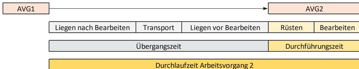
**Abbildung 6: Durchlaufzeitanteile eines Arbeitsvorgangs (vgl. Lödding, 2016, S. 59)**
