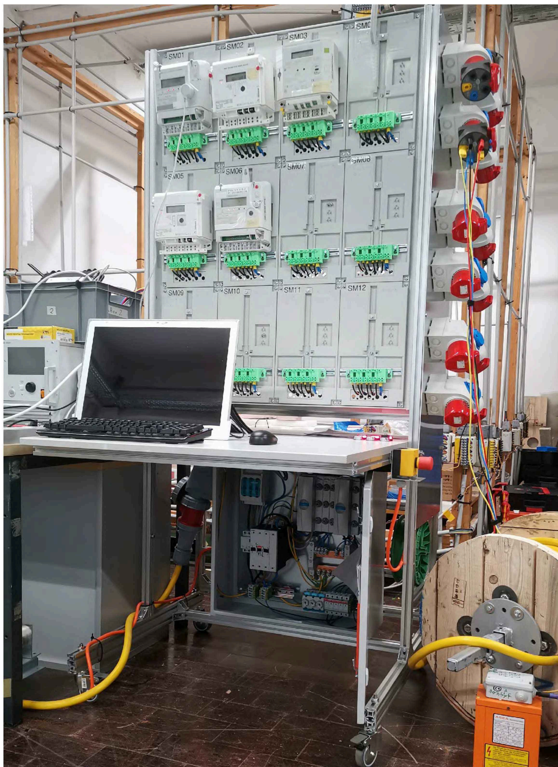
Abbildung 20: SM-Testaufbau Frontansicht mit offenem Verteilerkasten
