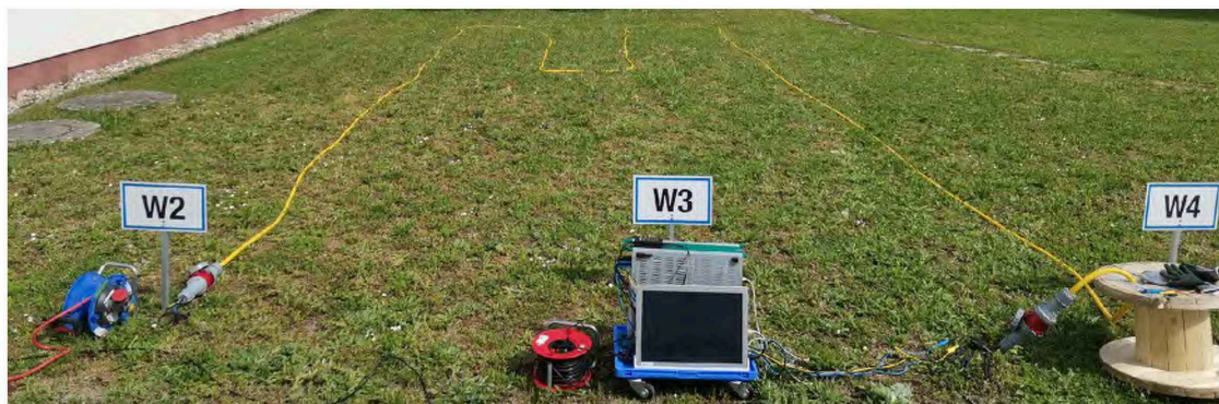
Abbildung 43: Kabel mit 5 \times 16 \text{ mm}^2 ausgerollt auf einer Wiese
