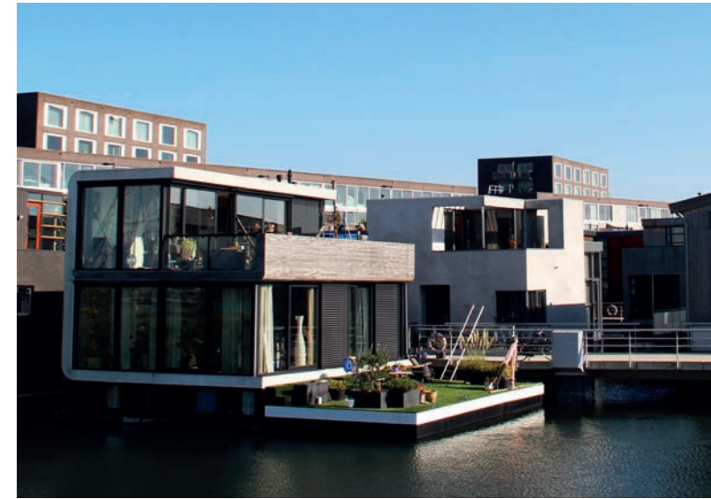
Abb. 12 schwimmendes Haus in Wannenbauweise | IJburg NL
