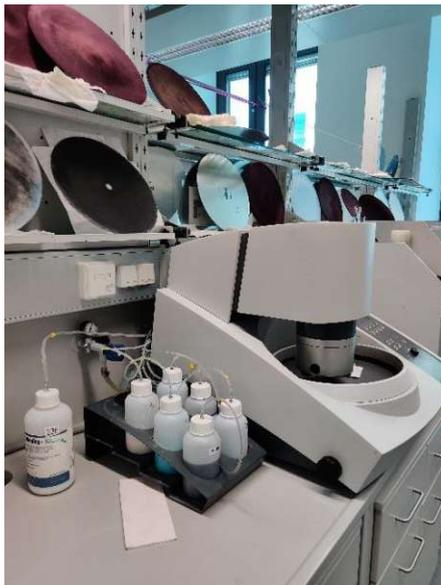
Abbildung 10: Tegramin-30 zum Schleifen und Polieren der Schlitze
