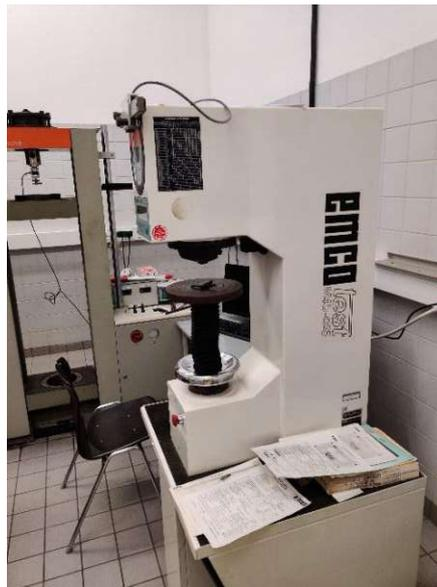
Abbildung 12: Härteprüfmaschine
