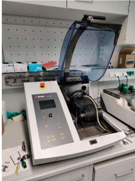
Abbildung 9: Accutom 10 zum Schneiden der gesinterten Proben
