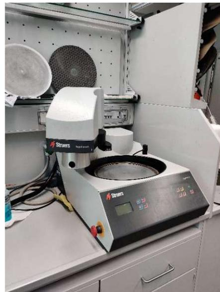
Abbildung 11: Tegrapol-31 zum Schleifen und Polieren der Schlitze
