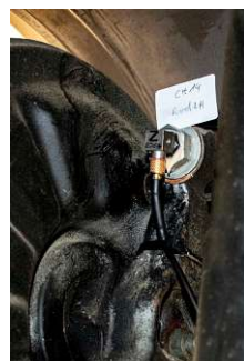
3D-Beschleunigungssensor Rad rechts hinten
