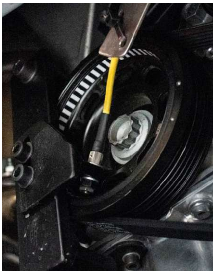
Abbildung 59: Appliziertes Schwarz-Weiß-Band [109] inklusive Stoßfehler und optischem Drehzahl-sensor [85] am TVD (Kurbelwellenanfang)
