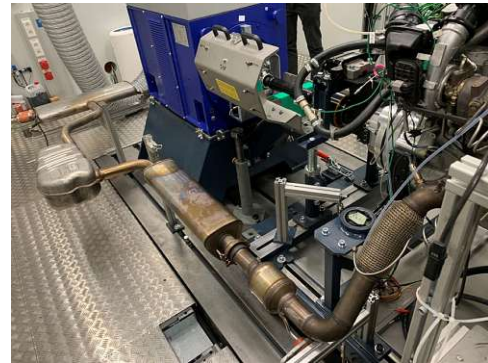
Gesamtaufbau ENG Abgasanlage
