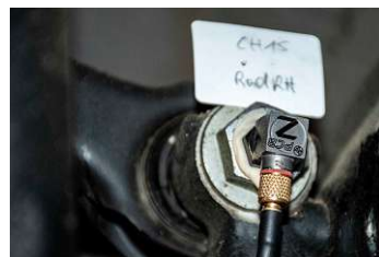
3D-Beschleunigungssensor Rad rechts hinten
