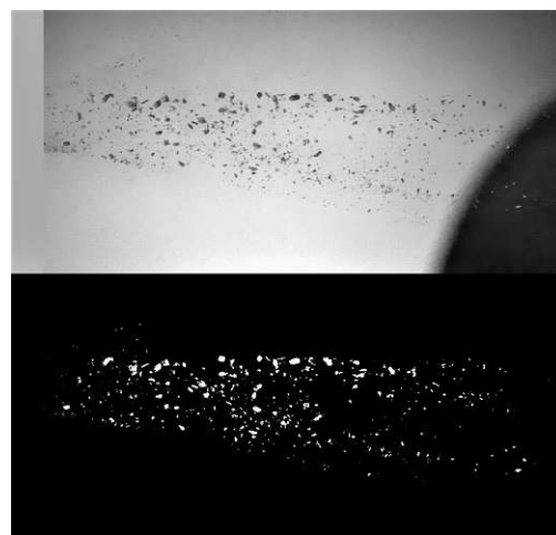
(d) Pellet #434, 100% Ne, 25° shatter tube, 260 m/s pellet speed.
