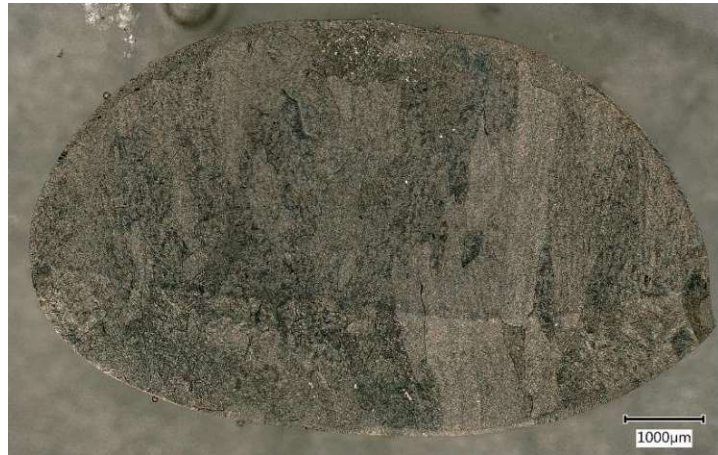
Abbildung 71: lichtmikroskopisches Übersichtsbild der geätzten wärmebehandelten Ti-4Al-2Fe-3Cu Probe aus dem Rinnenofen
