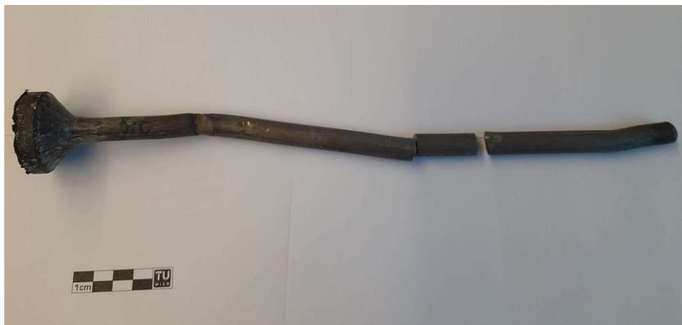
Abbildung 101: Ti + 3 vol% SiC (F500) nach dem Strangpressen bei 1000 °C
