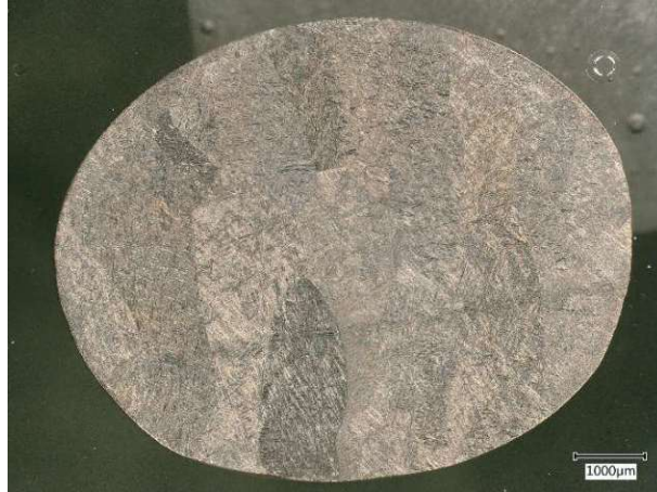
Abbildung 15: lichtmikroskopisches Übersichtsbild der geätzten wärmebehandelten Ti-6Al-4V Probe aus dem Rinnenofen
