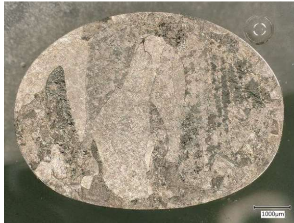
Abbildung 19: lichtmikroskopisches Übersichtsbild der geätzten wärmebehandelten Ti-6Al-2Fe-0,1Si Probe aus dem Rinnenofen
