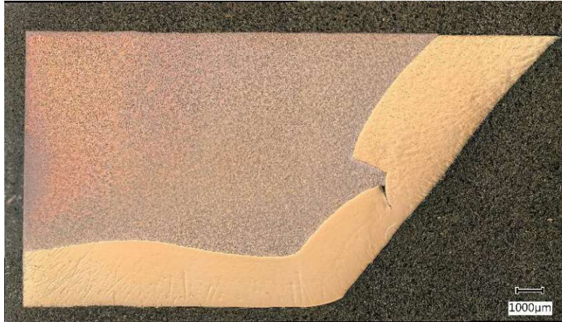
Abbildung 98: lichtmikroskopisches Übersichtsbild der beim Strangpressen gescheiterten, geätzten Ti + 3 vol% SiC (F500 / 950 °C) Probe
