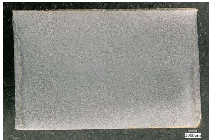
Abbildung 147: lichtmikroskopisches Übersichtsbild des geätzten, stranggepressten Ti-6Al-4V + 3 vol% B 4 C (F500 / 1000 °C) im Längsschliff
