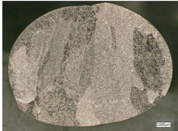
Abbildung 36: lichtmikroskopisches Übersichtsbild der geätzten wärmebehandelten Ti-3,75Al-2,5V-1,5Fe Probe aus dem Rinnenofen
