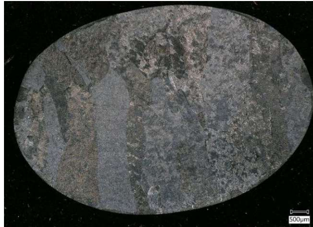
Abbildung 17: lichtmikroskopisches Übersichtsbild der geätzten Ti-6Al-2Fe-0,1Si Probe aus dem Rinnenofen
