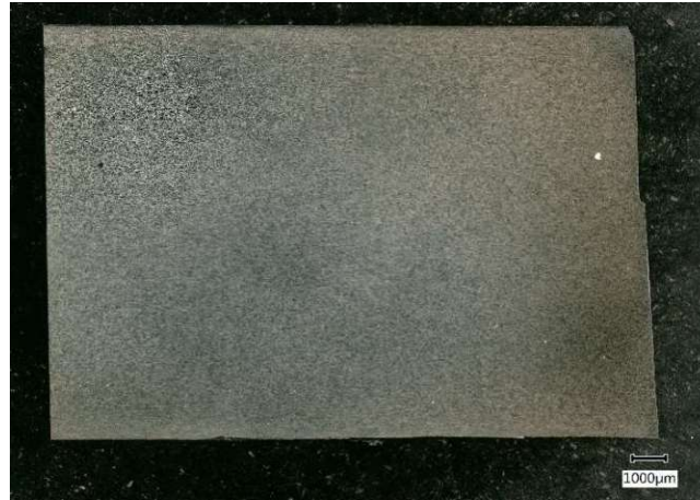
Abbildung 128: lichtmikroskopisches Übersichtsbild des geätzten, stranggepressten Ti + 3 vol% YSZ ( < 2 \mu\text{m} / 1000 \text{ }^\circ\text{C} ) im Längsschliff
