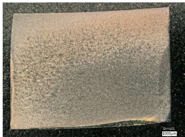
Abbildung 116: lichtmikroskopisches Übersichtsbild des geätzten, stranggepressten Ti + 3 \text{ vol\% } B_4C (F2000 / 1000 °C) im Längsschliff
