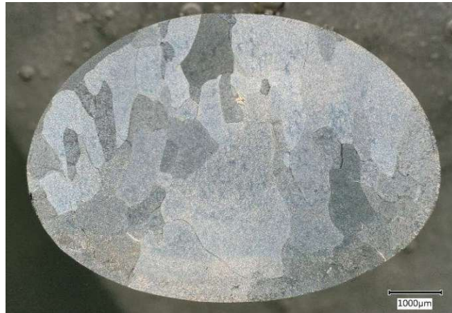
Abbildung 67: lichtmikroskopisches Übersichtsbild der geätzten wärmebehandelten Ti-10V-2Fe-3Al Probe aus dem Rinnenofen
