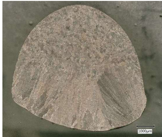
Abbildung 46: lichtmikroskopisches Übersichtsbild der geätzten wärmebehandelten Ti-5,91Al-3,94V-0,89Zr-0,61Y Probe aus dem Rinnenofen
