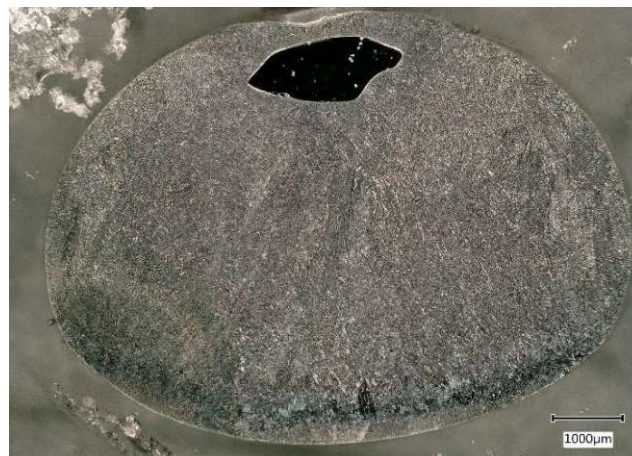
Abbildung 80: lichtmikroskopisches Übersichtsbild der geätzten wärmebehandelten Ti-7Al-1,5B Probe aus dem Rinnenofen
