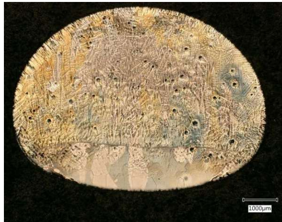
Abbildung 52: lichtmikroskopisches Übersichtsbild der geätzten Ti-5,7Al-3,8V-5Co Probe aus dem Rinnenofen
