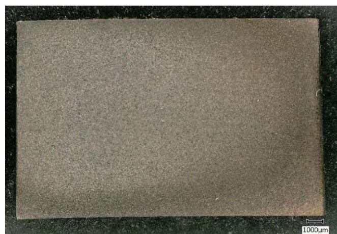
Abbildung 153: lichtmikroskopisches Übersichtsbild des geätzten, stranggepressten Ti-6,5Cu (1000 °C) im Längsschliff
