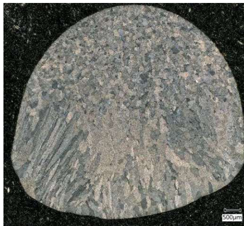
Abbildung 43: lichtmikroskopisches Übersichtsbild der geätzten Ti-5,91Al-3,94V-0,89Zr-0,61Y Probe aus dem Rinnenofen
