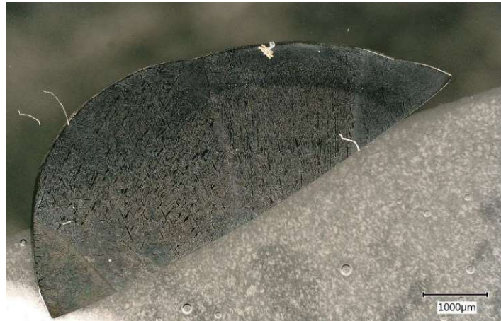
Abbildung 23: lichtmikroskopisches Übersichtsbild der geätzten wärmebehandelten Ti-8Al-1Mo-1V Probe aus dem Rinnenofen
