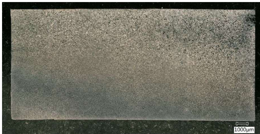
Abbildung 91: lichtmikroskopisches Übersichtsbild des geätzten, strangepressten Ti + 3 vol% SiC (F320 / 950 °C) im Längsschliff
