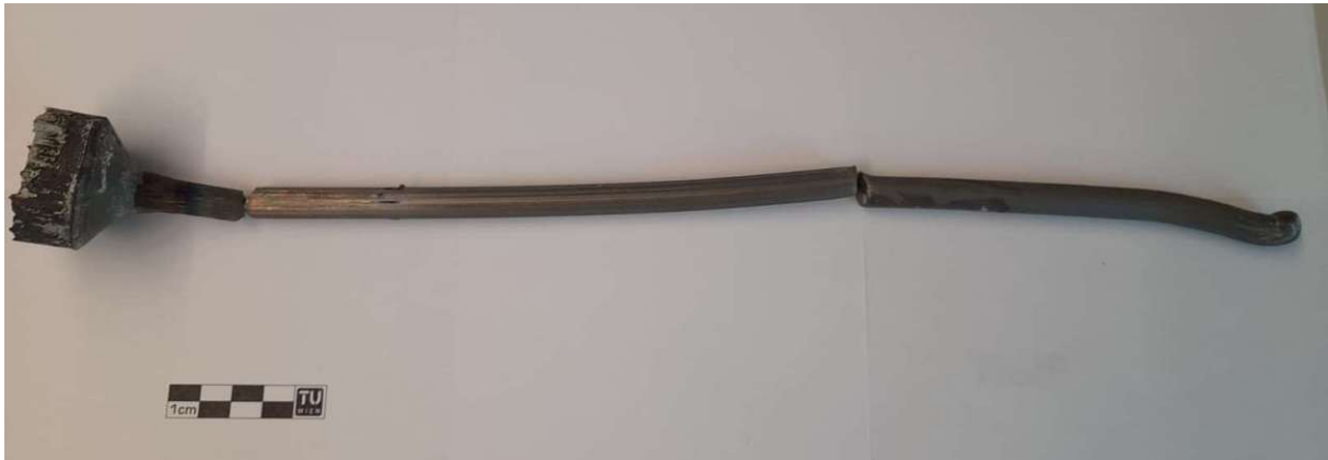
Abbildung 84: Ti Probe nach dem Strangpressen bei 950 °C
