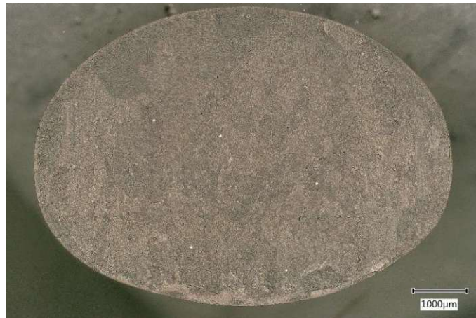
Abbildung 31: lichtmikroskopisches Übersichtsbild der geätzten wärmebehandelten Ti-5,61Al-3,74V-6,5Cu Probe aus dem Rinnenofen
