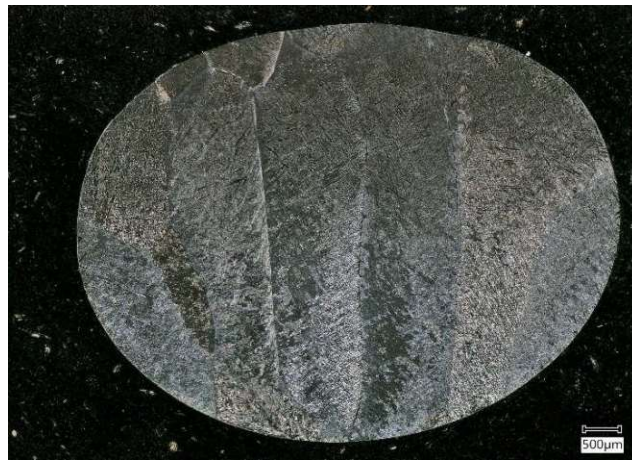
Abbildung 21: lichtmikroskopisches Übersichtsbild der geätzten Ti-8Al-1Mo-1V Probe aus dem Rinnenofen
