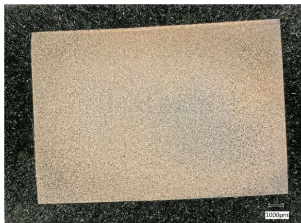
Abbildung 134: lichtmikroskopisches Übersichtsbild des geätzten, stranggepressten Ti + 3 \text{ vol\% } TiB_2 (1-10 \mu\text{m} / 1000 °C) im Längsschliff
