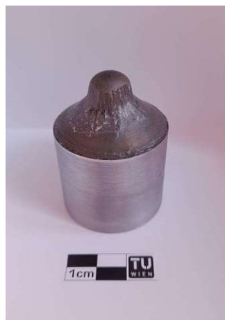
Abbildung 121: wieder auf einen Durchmesser von 40 mm gedrehte Kapsel nach dem gescheiterten Strangpressversuch von Ti + 3 vol% YSZ bei 950 °C (Anmerkung: Kapsel aus Baustahl)
