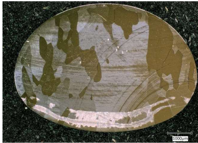
Abbildung 65: lichtmikroskopisches Übersichtsbild der geätzten Ti-10V-2Fe-3Al Probe aus dem Rinnenofen
