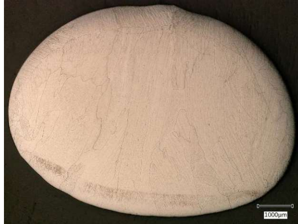
Abbildung 63: lichtmikroskopisches Übersichtsbild der geätzten wärmebehandelten Ti-13V-11Cr-3Al Probe aus dem Rinnenofen
