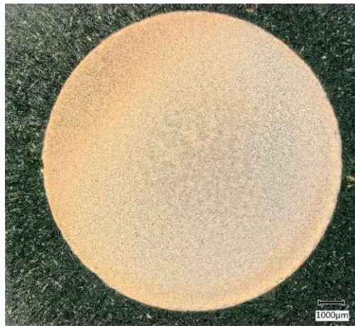
Abbildung 133: lichtmikroskopisches Übersichtsbild des geätzten, stranggepressten Ti + 3 \text{ vol\% } TiB_2 (1-10 \mu\text{m} / 1000 °C) im Querschliff
