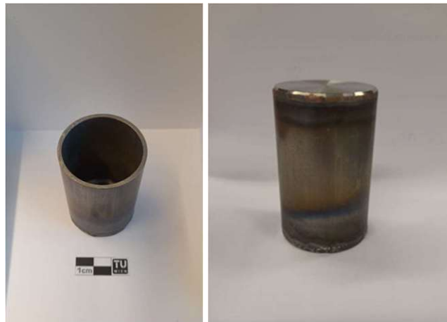
Abbildung 8: exemplarische Abbildung der verwendeten Baustahlkapseln beim Strangpressen
