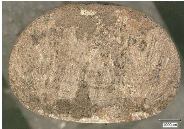
Abbildung 54: lichtmikroskopisches Übersichtsbild der geätzten wärmebehandelten Ti-5,7Al-3,8V-5Co Probe aus dem Rinnenofen
