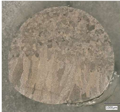
Abbildung 41: lichtmikroskopisches Übersichtsbild der geätzten wärmebehandelten Ti-5,94Al-3,96V-0,60Zr-0,40Y Probe aus dem Rinnenofen
