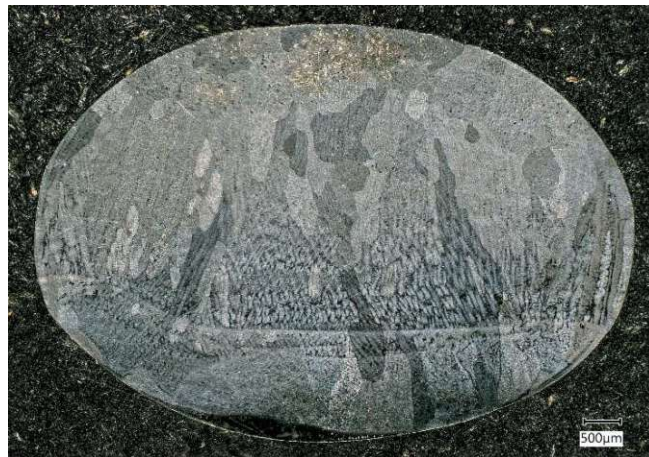
Abbildung 29: lichtmikroskopisches Übersichtsbild der geätzten Ti-5,61Al-3,74V-6,5Cu Probe aus dem Rinnenofen
