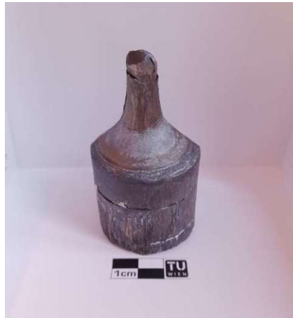
Abbildung 97: Bild der Kapsel nach dem gescheiterten Strangpressversuch von Ti + 3 vol% SiC (F500) bei 950 °C (Anmerkung: Kapsel aus 1.4301 Stahl, auf Foto schon halbiert)
