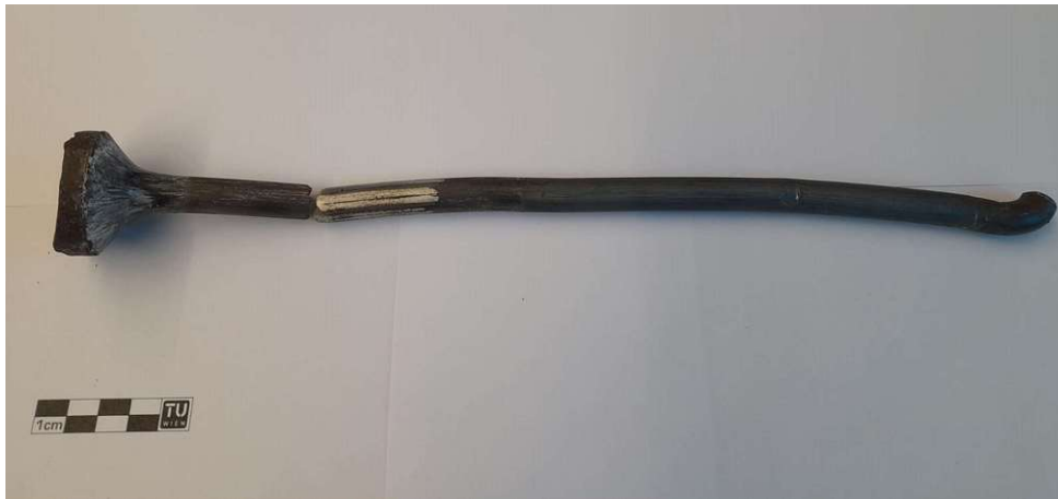
Abbildung 126: Ti + 3 vol% YSZ ( < 2 \mu\text{m} ) nach dem Strangpressen bei 1000 °C
