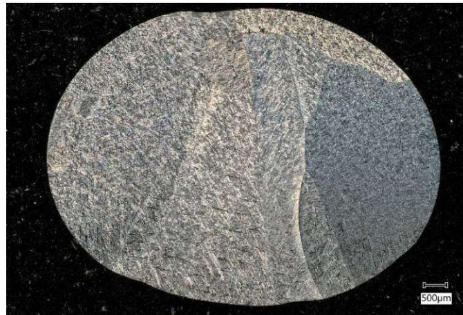
Abbildung 25: lichtmikroskopisches Übersichtsbild der geätzten Ti-8Al-2Mo-1V Probe aus dem Rinnenofen
