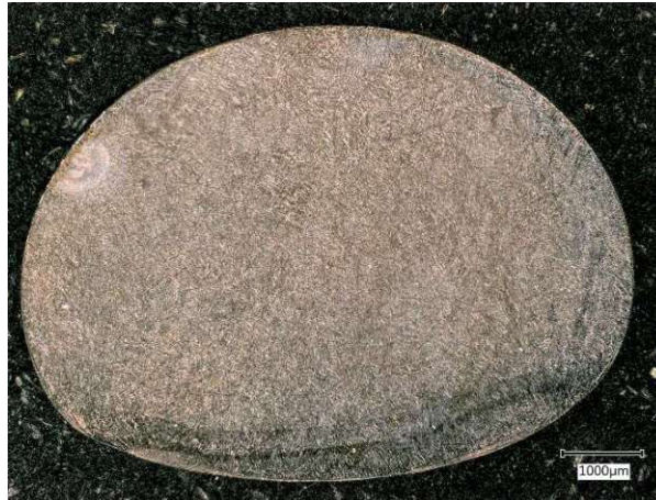
Abbildung 77: lichtmikroskopisches Übersichtsbild der geätzten Ti-7Al-1,5B Probe aus dem Rinnenofen
