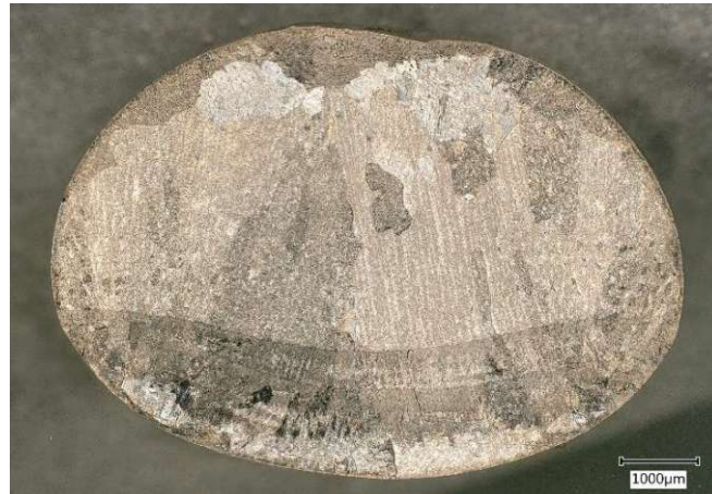
Abbildung 59: lichtmikroskopisches Übersichtsbild der geätzten wärmebehandelten Ti-5,7Al-3,8V-3,3Co-1,4Cr-0,3Mo Probe aus dem Rinnenofen
