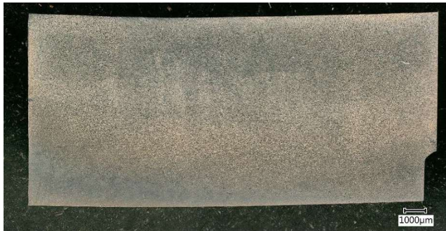
Abbildung 109: lichtmikroskopisches Übersichtsbild des geätzten, stranggepressten Ti + 3 \text{ vol\% } B_4C (F500 / 950 °C) im Längsschliff
