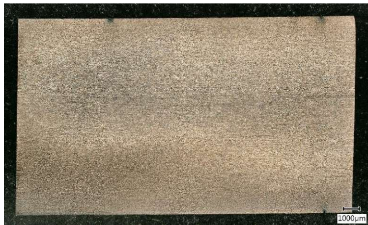
Abbildung 103: lichtmikroskopisches Übersichtsbild des geätzten, stranggepressten Ti + 3 vol% SiC (F500 / 1000 °C) im Längsschliff
