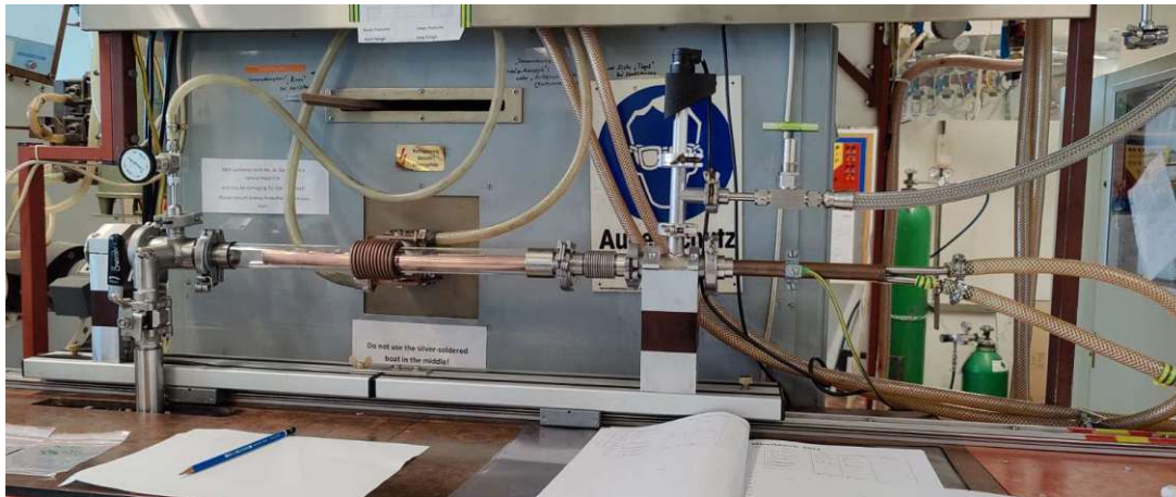
Abbildung 6: Rinnenofen zum Schmelzen von kleinen Metallmengen (ca. 2 g) (E138, TU Wien)
