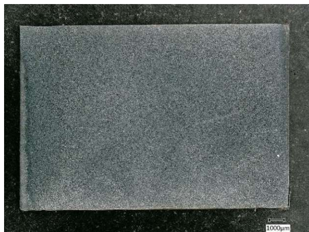
Abbildung 141: lichtmikroskopisches Übersichtsbild des geätzten, stranggepressten Ti-6Al-4V (1000 °C) im Längsschliff
