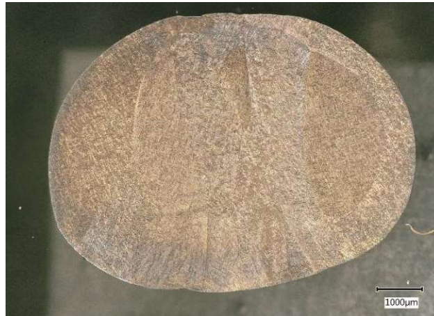
Abbildung 27: lichtmikroskopisches Übersichtsbild der geätzten wärmebehandelten Ti-8Al-2Mo-1V Probe aus dem Rinnenofen
