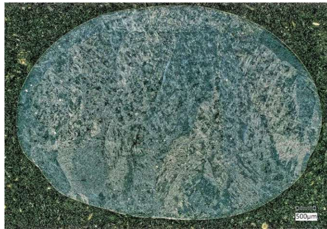
Abbildung 48: lichtmikroskopisches Übersichtsbild der geätzten Ti-6Al-5Zr-0,5Mo-0,25Si Probe aus dem Rinnenofen
