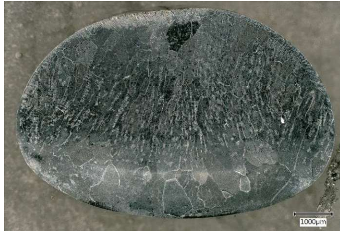
Abbildung 75: lichtmikroskopisches Übersichtsbild der geätzten wärmebehandelten Ti-1Al-8V-5Fe Probe aus dem Rinnenofen
