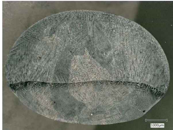
Abbildung 50: lichtmikroskopisches Übersichtsbild der geätzten wärmebehandelten Ti-6Al-5Zr-0,5Mo-0,25Si Probe aus dem Rinnenofen
