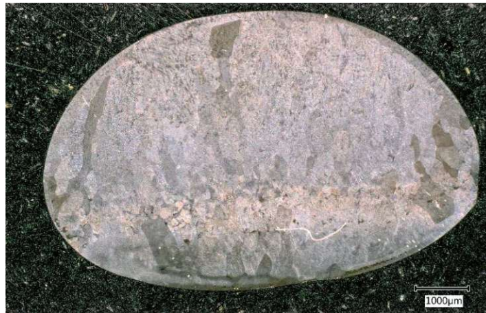
Abbildung 69: lichtmikroskopisches Übersichtsbild der geätzten Ti-4Al-2Fe-3Cu Probe aus dem Rinnenofen
