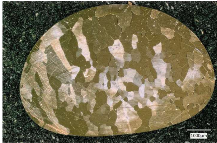
Abbildung 73: lichtmikroskopisches Übersichtsbild der geätzten Ti-1Al-8V-5Fe Probe aus dem Rinnenofen
