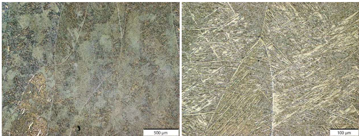
Abbildung 20: mit verdünnter HF geätzter Schliff der wärmebehandelten Ti-6Al-2Fe-0,1Si Probe (1,5 Stunden bei 850 °C) aus dem Rinnenofen
