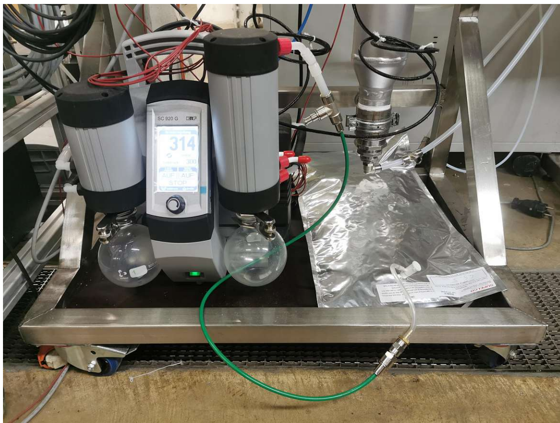
Abbildung 5.1: Versuchsaufbau zur Füllung der Samplebags
