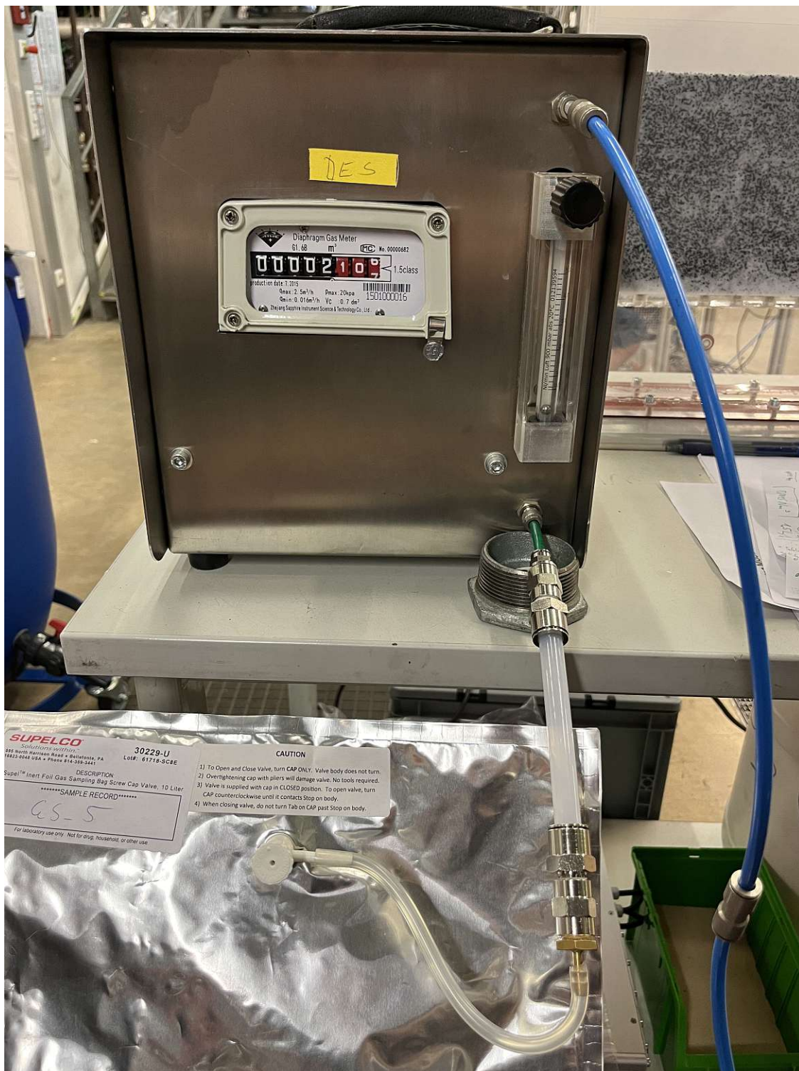
Abbildung 5.2: Messung des Samplebaginhalts mithilfe einer Gasuhr
