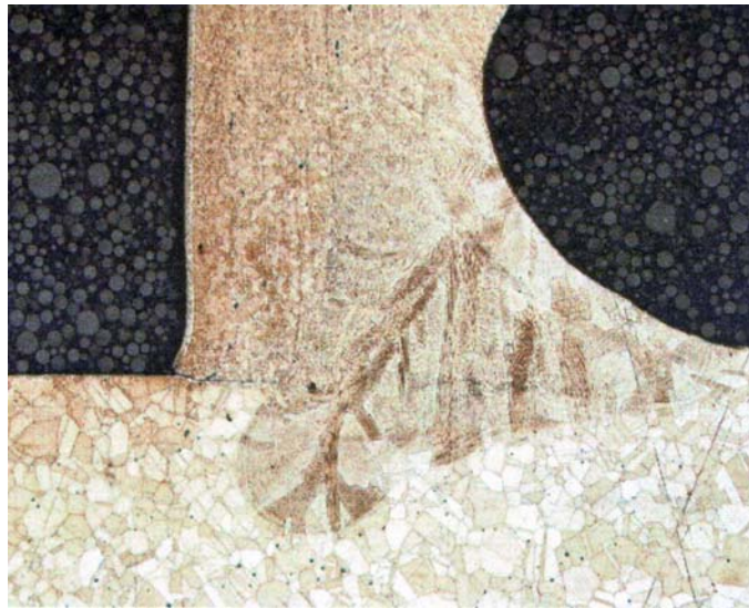
Abbildung 4-8 Schweißverbindung Teller/Rohr (eine Seite), ungeätzter Längsschliff
