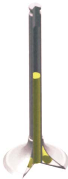
Abbildung 1-3 Natriumfüllung am LBV (Quelle: Mahle Ventiltrieb GmbH)
