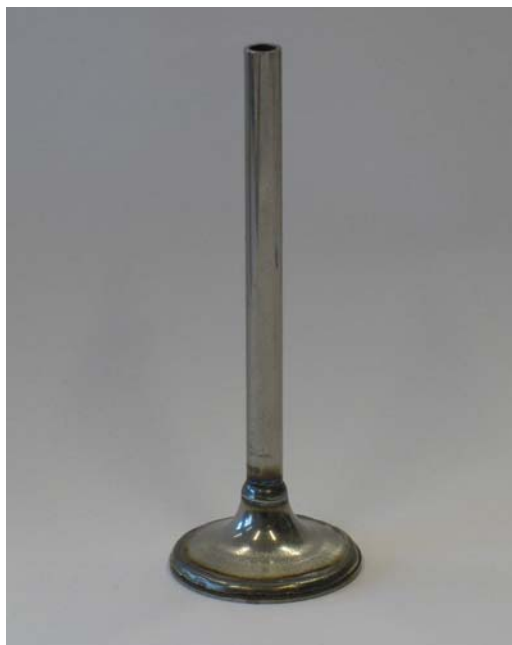
Abbildung 9-1 Rohventil nach dem Laserschweißen ohne Ventilschaftende (VSE)
