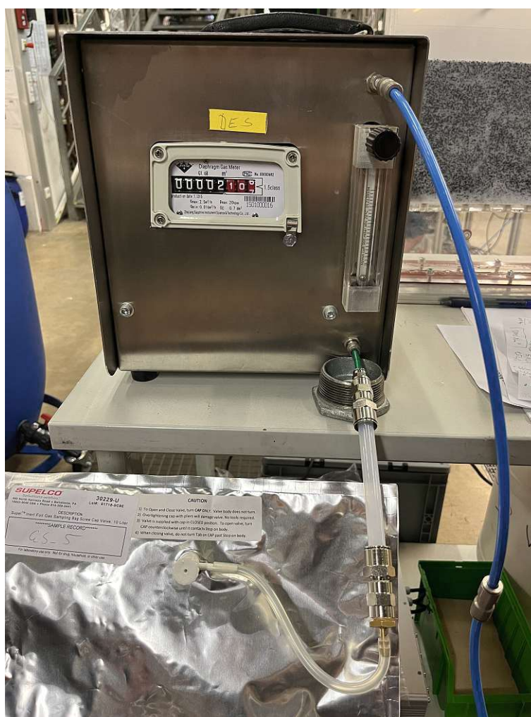
Abbildung 4.5: Validierungsversuche mit Samplebag und Gasuhr
