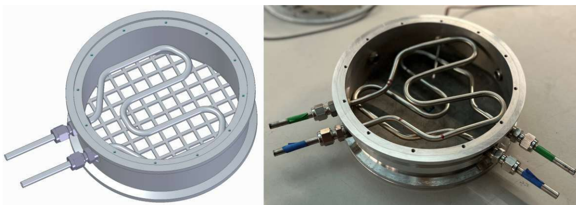
Abbildung 3.3: Festbett mit integriertem Wärmetauscher
