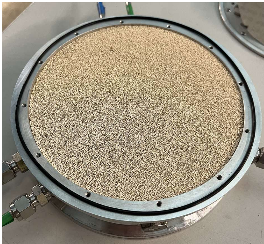
Abbildung 3.6: Mit Adsorbens befülltes Festbett
