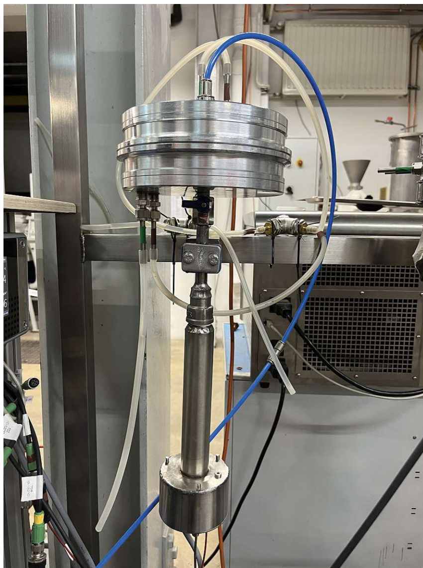
Abbildung 3.5: Unter dem Festbett liegender Verdampfer
