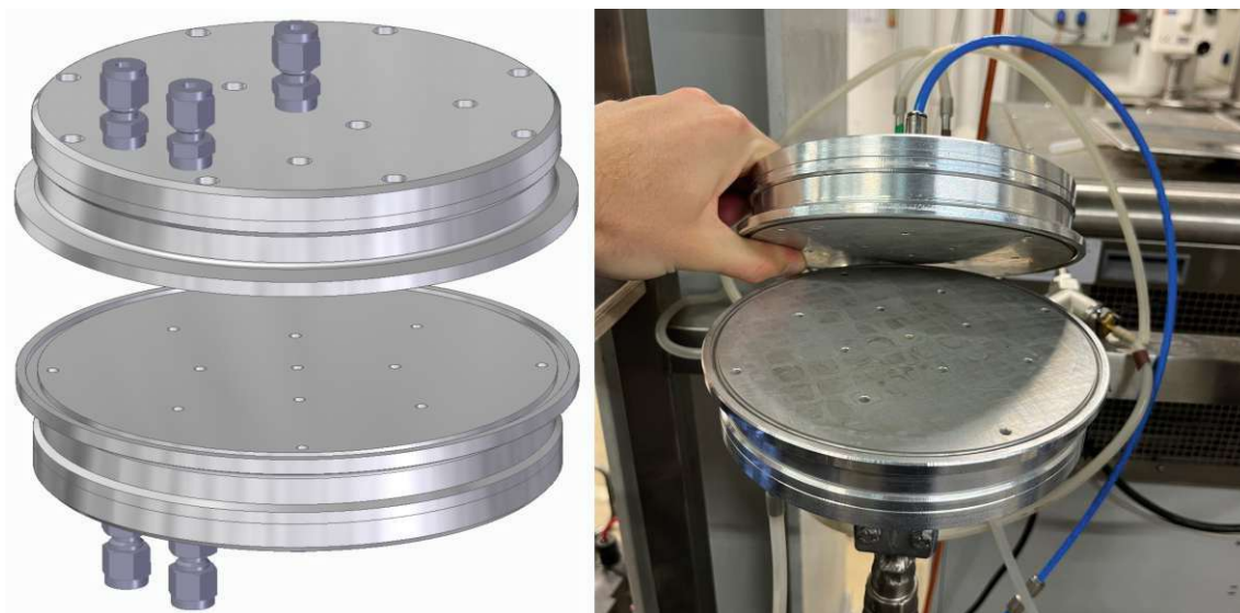
Abbildung 3.4: Stirnseitige Heizplatten für Festbett mit Dampfauslässen
