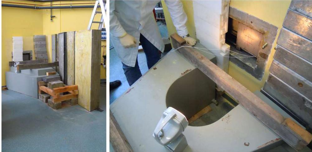
Abbildung 1.3: Links: Der Borsäuretank vor dem Auslass. Rechts: Das unterste Element des Borsäuretanks.
