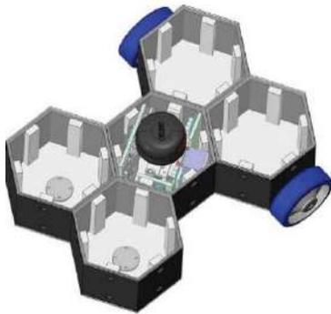
(a) Konfiguration mit Differentialantrieb - Zwei Antriebsräder und zwei Stützrollen
