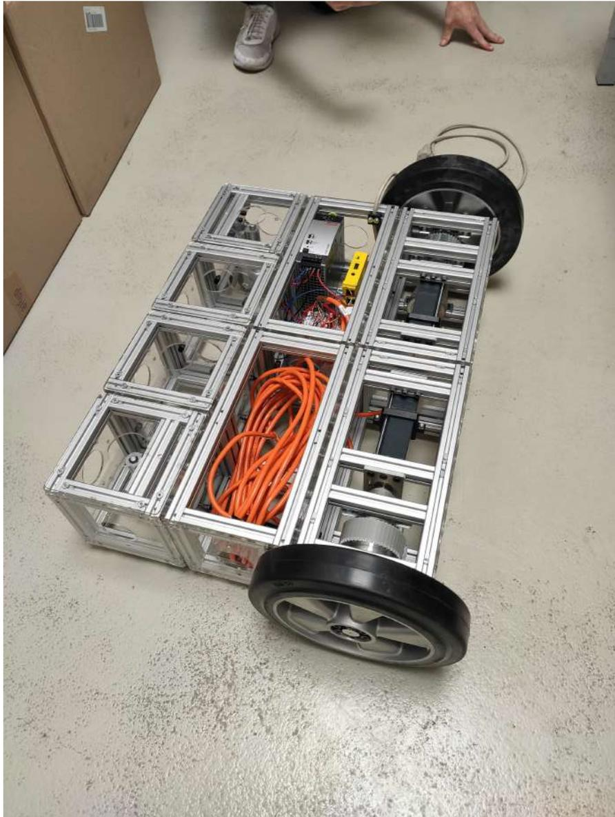
Abbildung 7.1: Testkonfiguration des mobilen Roboters mit zwei Antriebsmodulen als Differentialantrieb
