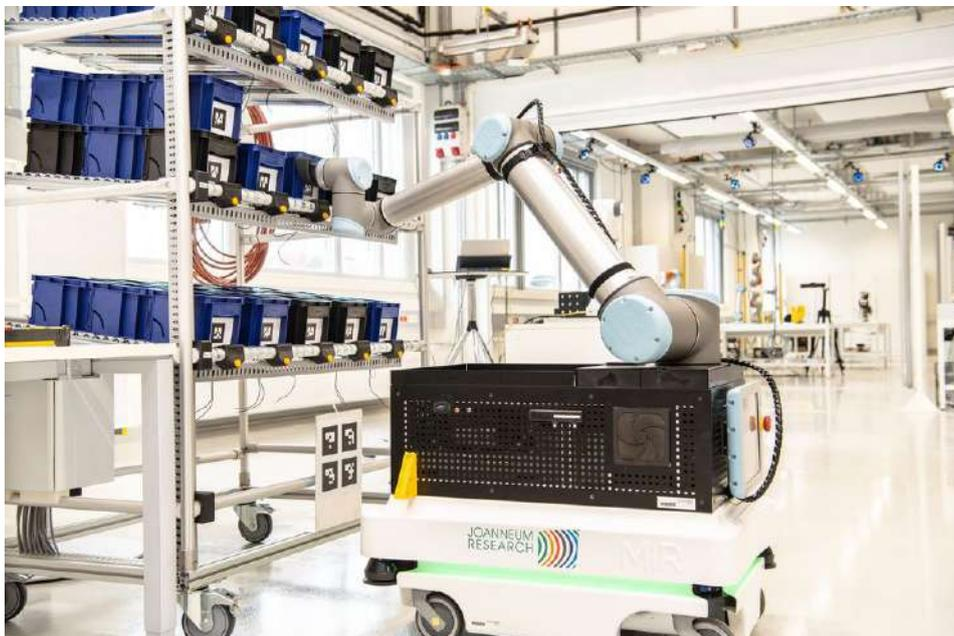
Abbildung 2.8: Mobiler Manipulator „CHIMERA“ von Joanneum Research, bestehend aus den zwei Subsystemen mobile Plattform „MiR 100“ und Roboter „UR10“
