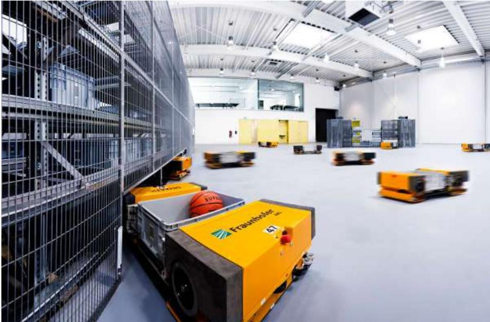
Abbildung 2.7: FTS in der Versuchshalle des Fraunhofer IML [30]
