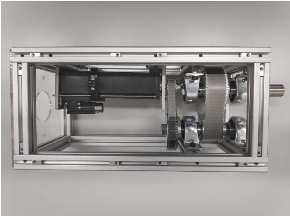
Abbildung 6.11: Fertiger Prototyp des Antriebsmoduls in Vorderansicht
