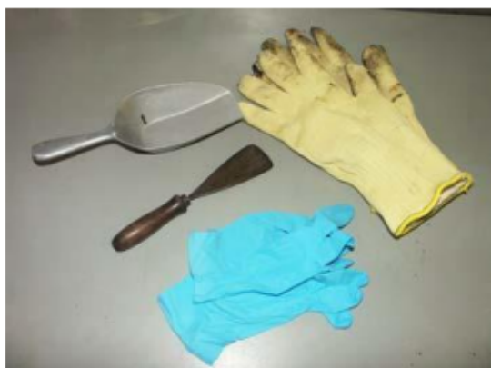
Abb. 4.10: Hilfsmittel zum Entnehmen und Zerteilen der Probe, TU Wien
