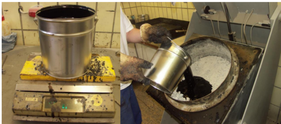
Abb. 4.5: Einwaage des Bindemittels und Beigabe zur Mischtrommel
