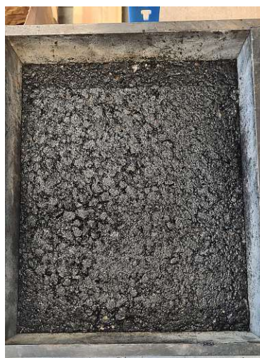
Abb. 4.7: Vorbereitete Platte für die Spurbildungsversuche
