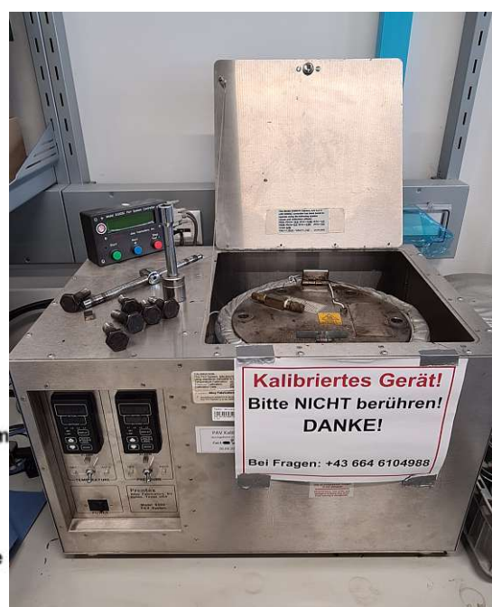
Abb. 5.8: Prüfvorrichtung PAV Fa. Prentex
