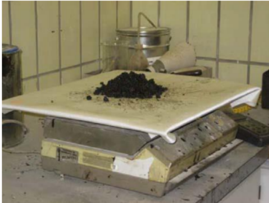
Abb. 4.8: Einwaage des Mischguts, TU Wien
