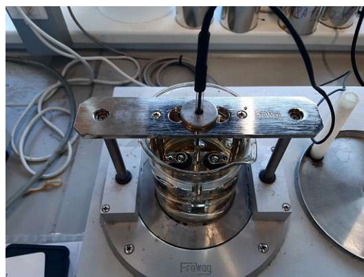
Abb. 5.1: Prüfeinrichtung des Erweichungspunktes nach Ring und Kugel
