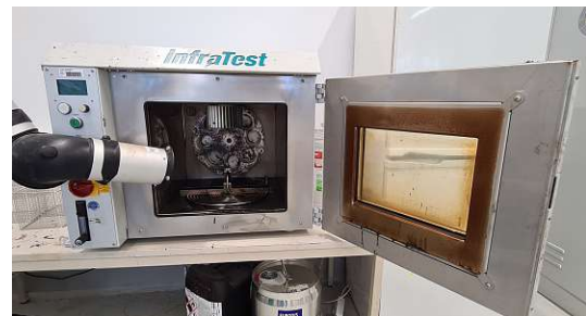
Abb. 5.6: RTFOT Prüfeinrichtung Fa.Infracore
