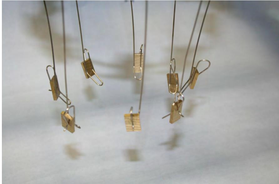
Abbildung 25: Befestigung und Anordnung der Proben
