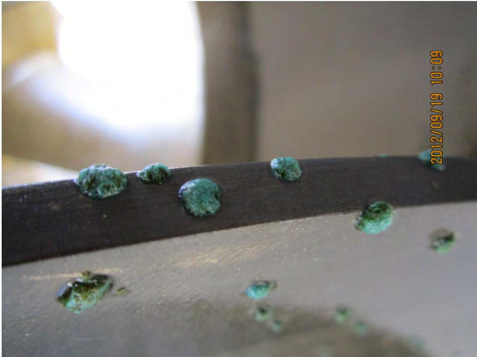
Abbildung 4: Pusteln aus Malachit bedecken die Oberfläche<sup>[2]</sup>
