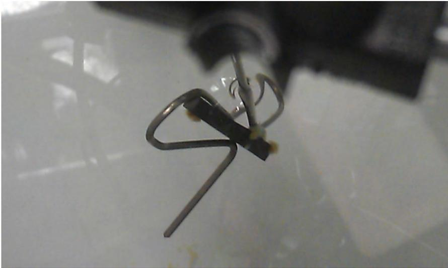
Abbildung 29: ein Beispiel für lokalisierten Angriff an einer gebeizten Probe
