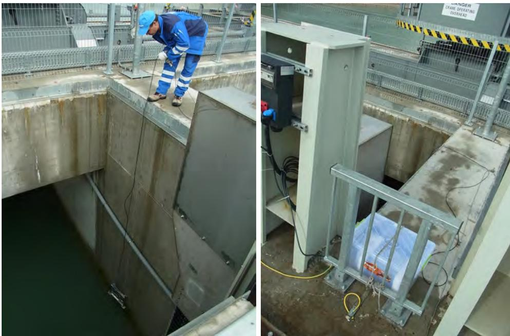
Abbildung 60: Absenken des Racks in einen der Turbinenschächte und Box mit Messelektronik<sup>[2]</sup>
