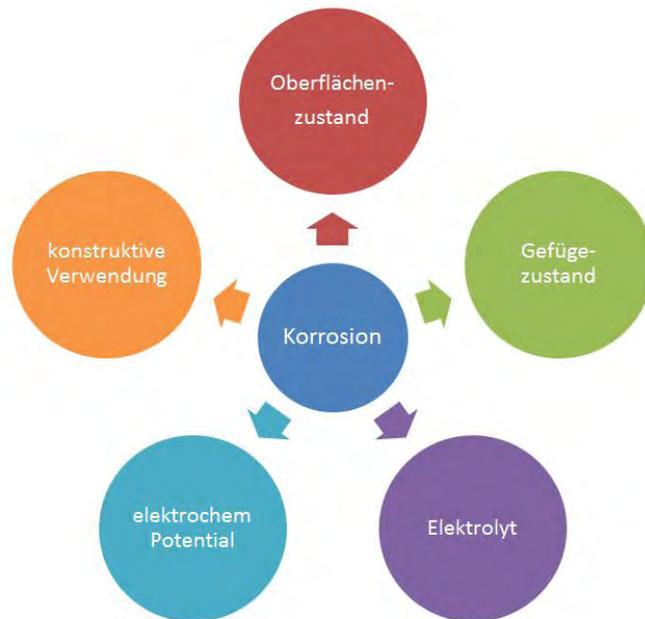
Abbildung 12: Schema zu korrosionsbeeinflussenden Parametern
