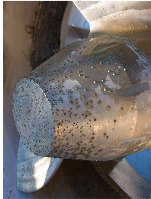
Abbildung 3: Korrosion an einem Laufrad<sup>[2]</sup>
