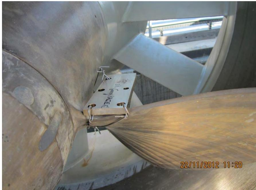
Abbildung 55: Leitend am Laufrad befestigtes Auslagerungsteil<sup>[1]</sup>
