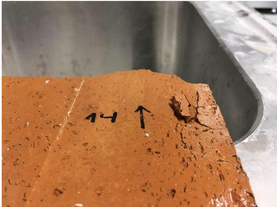
Abbildung 10: Typisches Schadensbild von Keramiken durch Frost
