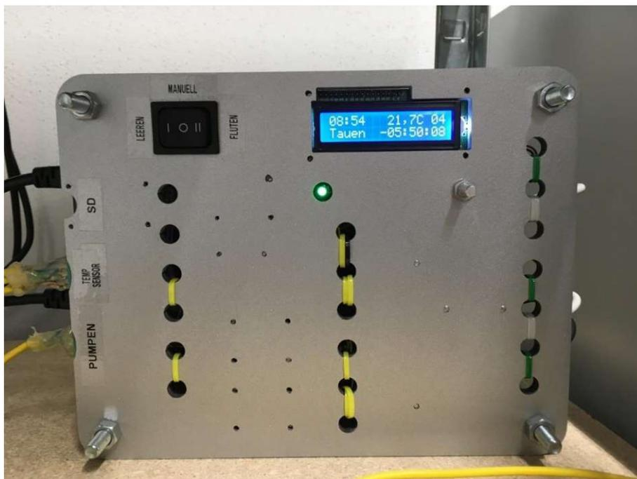
Abbildung 5: Fertiggestellte Hardware der Pumpensteuerung
