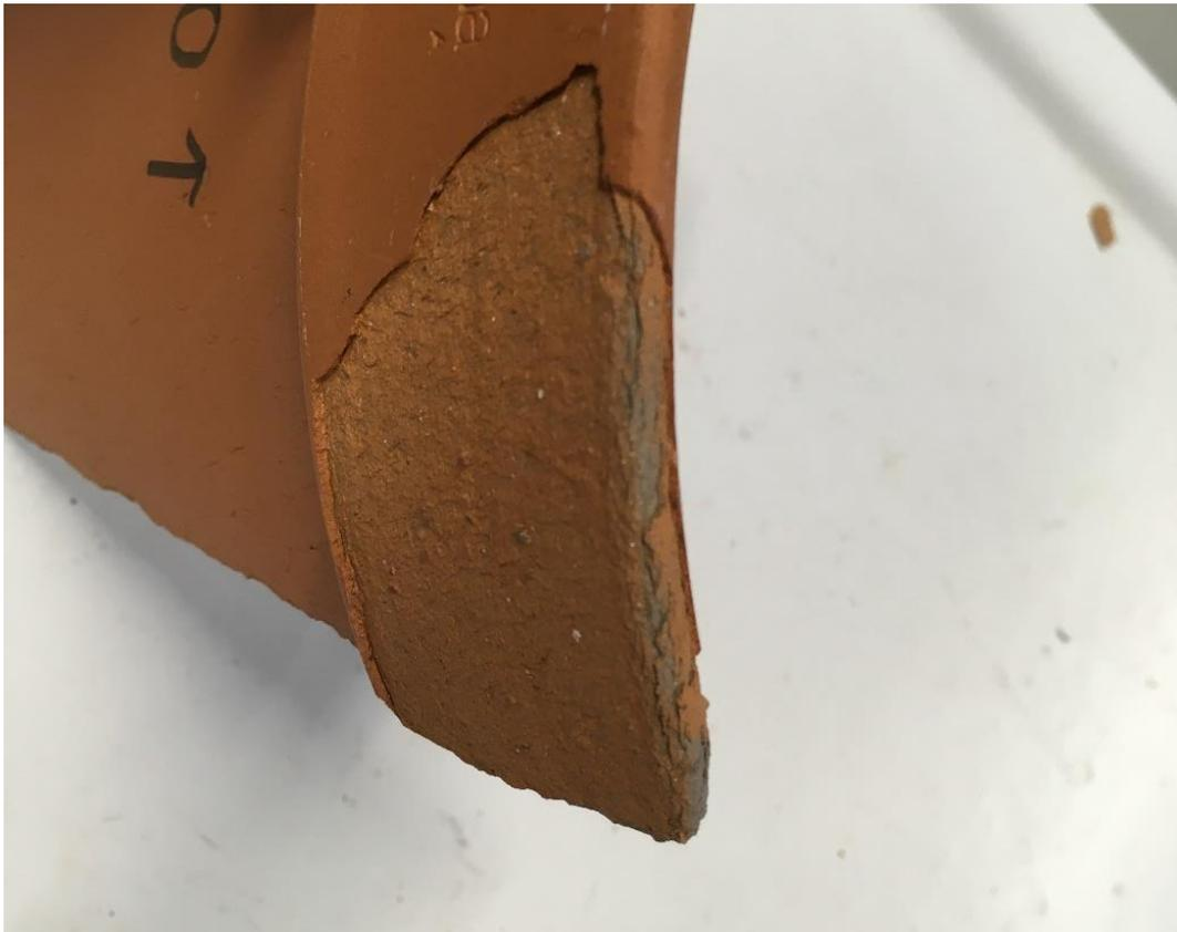
Abbildung 25: Probe 10, Frostschäden entlang der Schichtgrenzen
