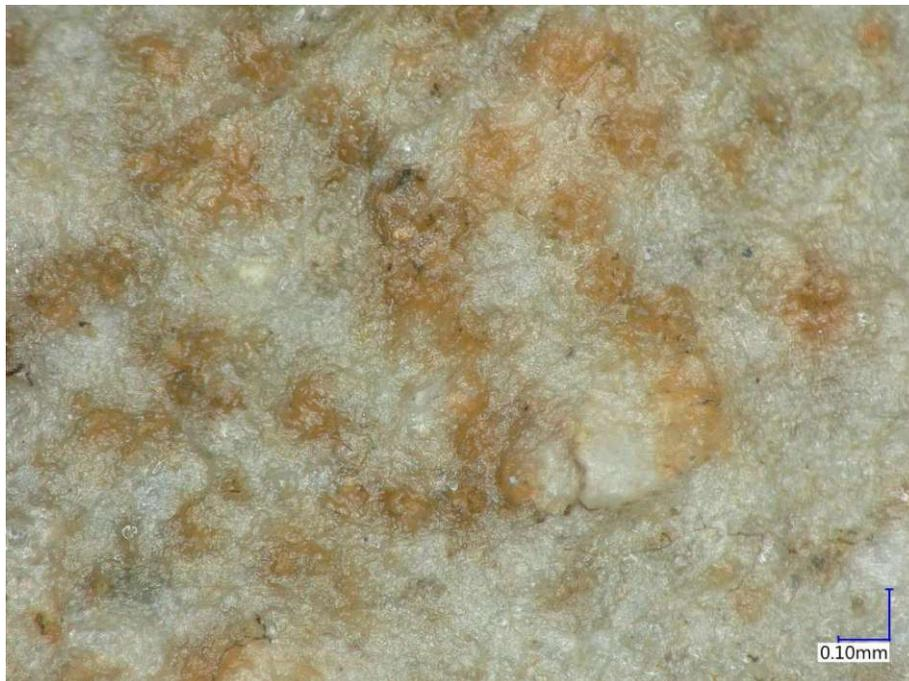
Abbildung 9: Glasartige Struktur durch Brenntemperaturen über der Sintergrenze, Probe 08
