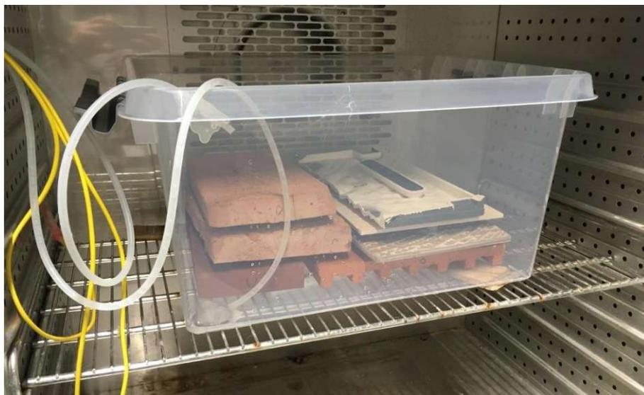
Abbildung 19: Probekörper mit Abstandhalter im eingebauten Zustand
