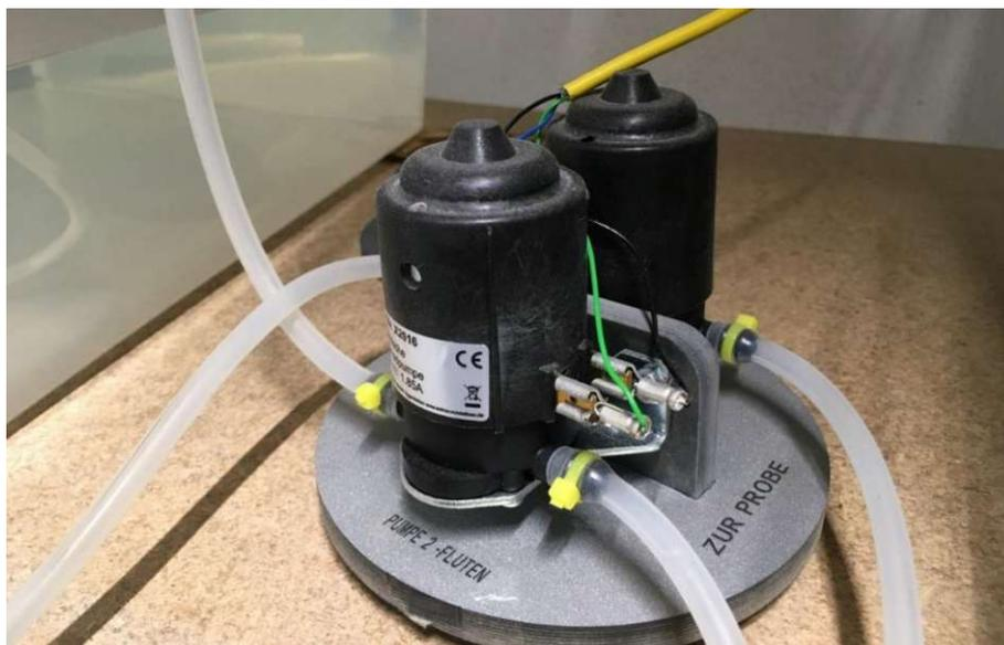
Abbildung 18: Zahnradpumpen außerhalb des Klimaschranks
