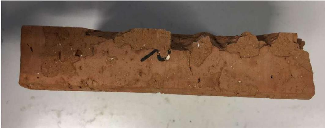
Abbildung 27: Probe 14, nach 26 Frost/Tau-Zyklen
