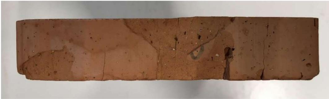
Abbildung 24: Probe 04, nach 122 Frost/Tau-Zyklen
