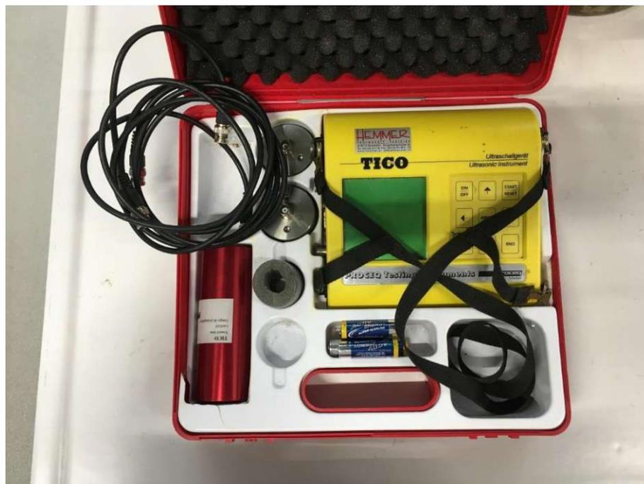
Abbildung 12: Ultraschall-Messeinheit
