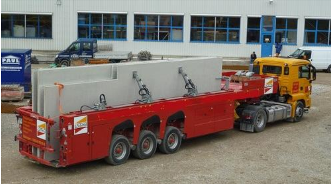
Abb 62: Tiefbettsattellastkraftwagen mit Transportgestell [37]
