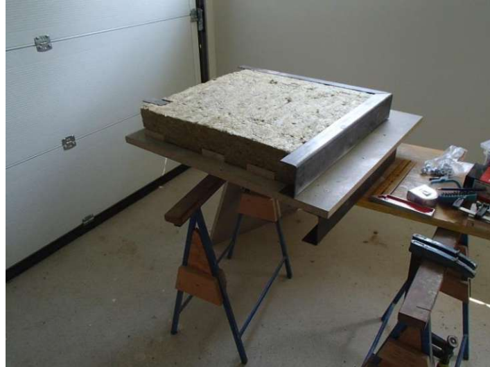
Abb 69: Verlegung der Inneren Dämmebene
