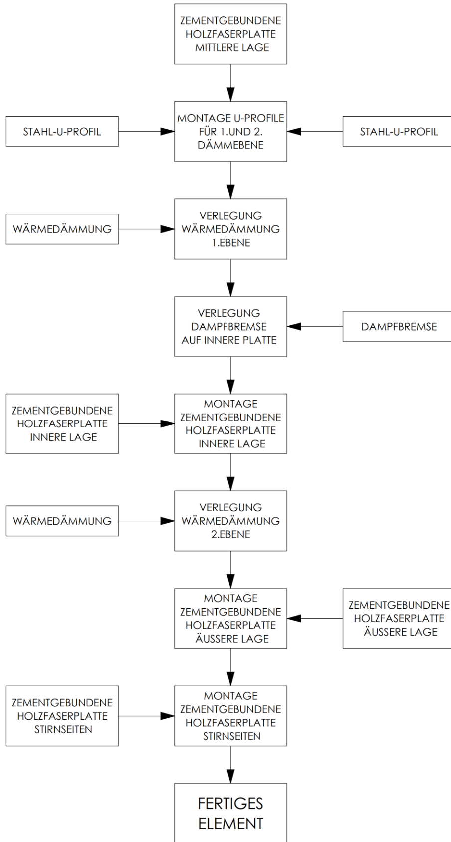
Abb 57: Elementherstellungsprozess
