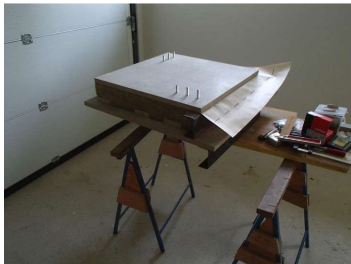
Abb 70: Montage Dampfbremse sowie Innere Platte
