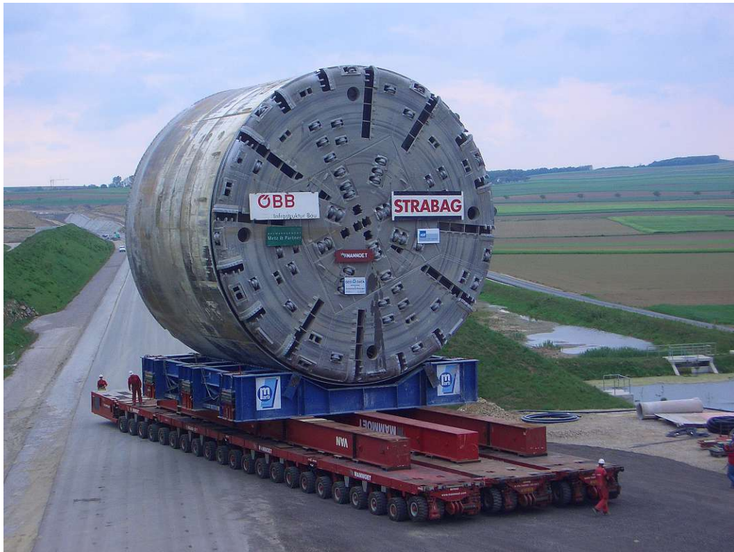
Abb. 3.19: Schildtransfer der TBM-S der Tunnelkette Perschling (Quelle: [69] Strabag AG)
