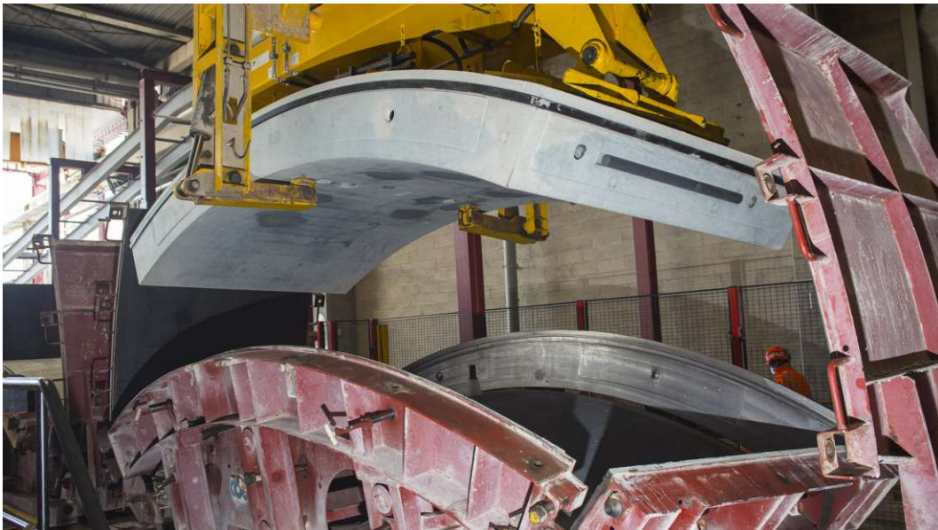
Abb. 2.10: Tübbing mit Schalung (Quelle: [44] Implenia AG)
