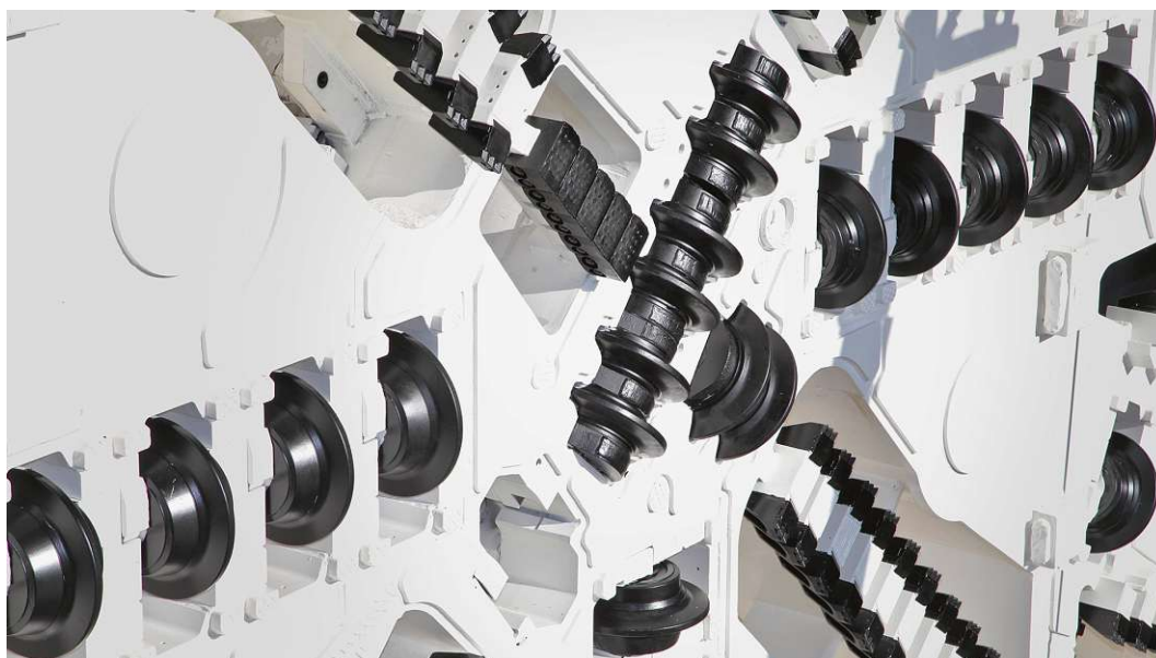
Abb. 2.7: Bohrkopf mit verschiedenen Abbauwerkzeugen (Quelle: [31] Herrenknecht AG)
