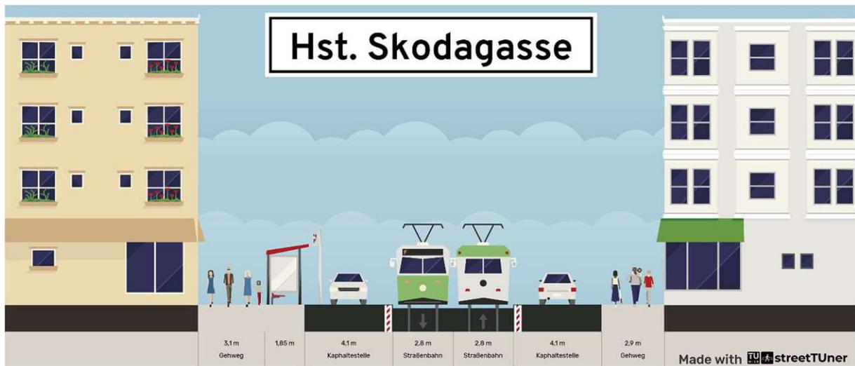
Abb. 24: Querschnitt Haltestelle Skodagasse. Quelle: TU Wien – StreetTuner (streettuner.fvv.tuwien.ac.at)
