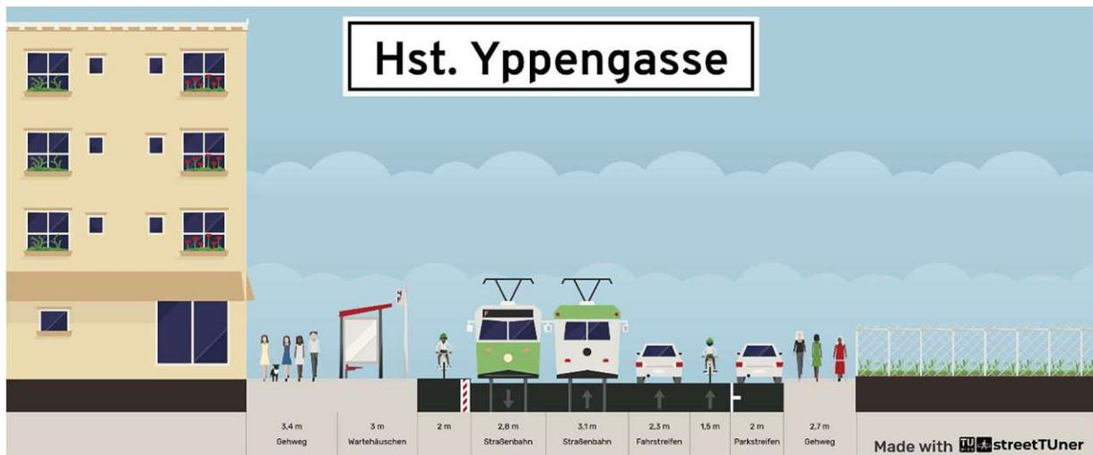
Abb. 28: Querschnitt Haltestelle Yppengasse. Quelle: TU Wien – StreetTuner (streettuner.fvv.tuwien.ac.at)
