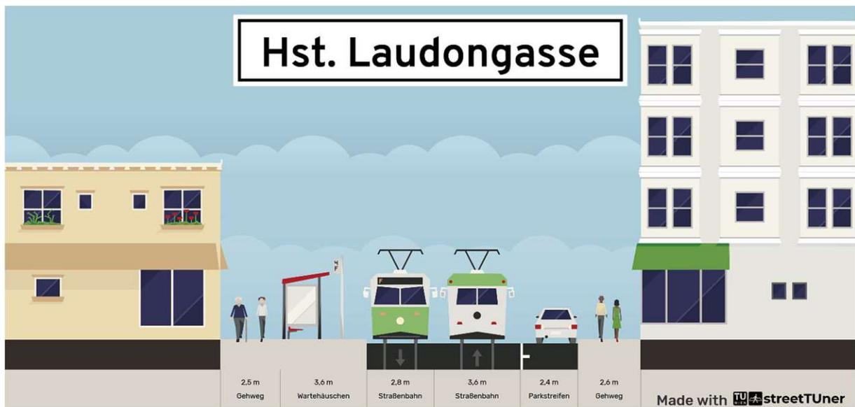
Abb. 18: Querschnitt Haltestelle Laudongasse. Quelle: TU Wien – StreetTuner (streettuner.fvv.tuwien.ac.at)
