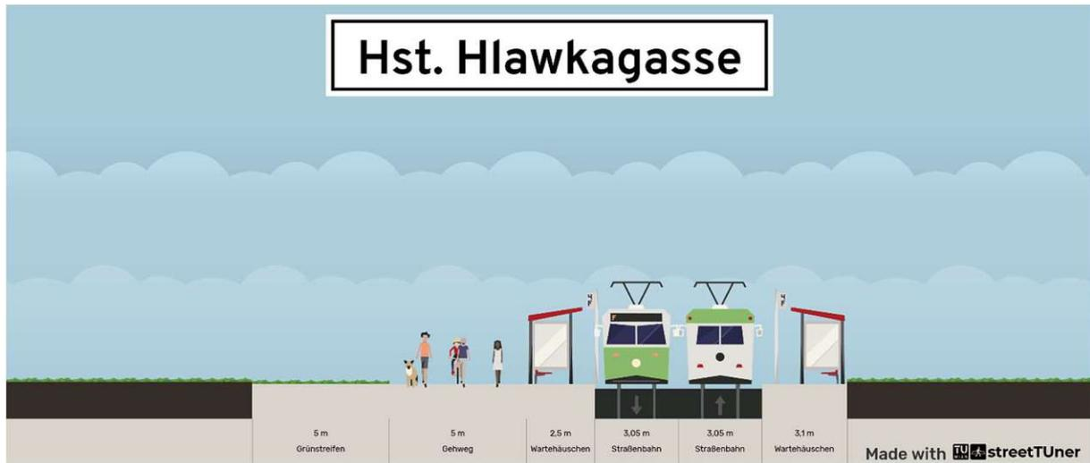
Abb. 19: Querschnitt Haltestelle Hlawkagasse. Quelle: TU Wien – StreetTuner (streettuner.fvv.tuwien.ac.at)
