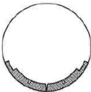
Zurückziehen des Pressendruckringes und Setzen der Sohltübbinge
