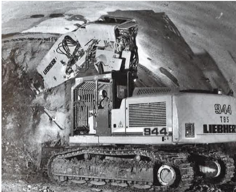
Abbildung 7: Tunnelbagger mit 2x45° um die Längsachse schwenkbarem Arm [11]
