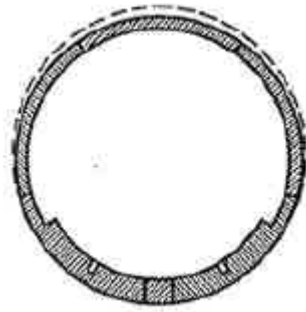
Abbildung 40: Schematischer Aufbau einer Röhre mit Hexagonaltübbingen [2]
