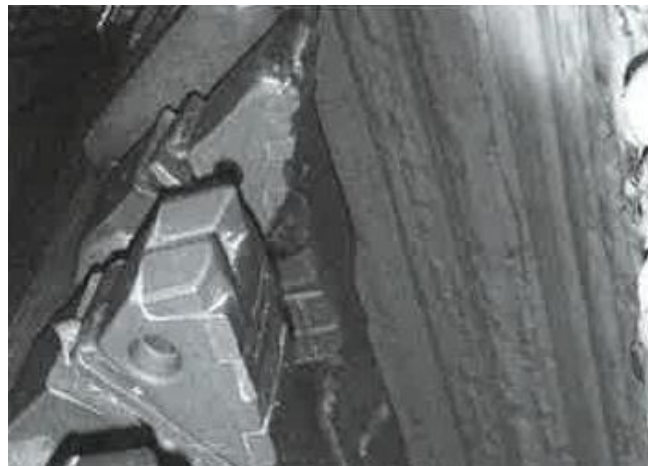
Abbildung 33: schmale Schälmesser mit unterschiedlichem Freiwinkel und Rückenschutz in aufgesetzten Haltern [2]
