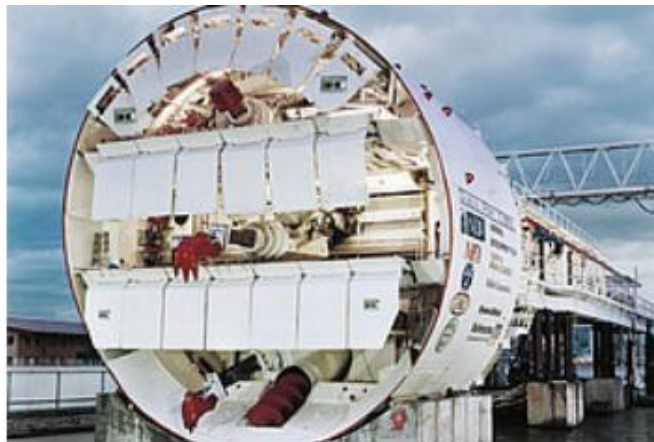
Abbildung 18: schematische Darstellung einer Teilschnittmaschine mit mechanischer Ortsbruststützung [18]
