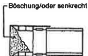
Abbildung 19: Systemskizze – Natürliche Stützung [8], [13]
